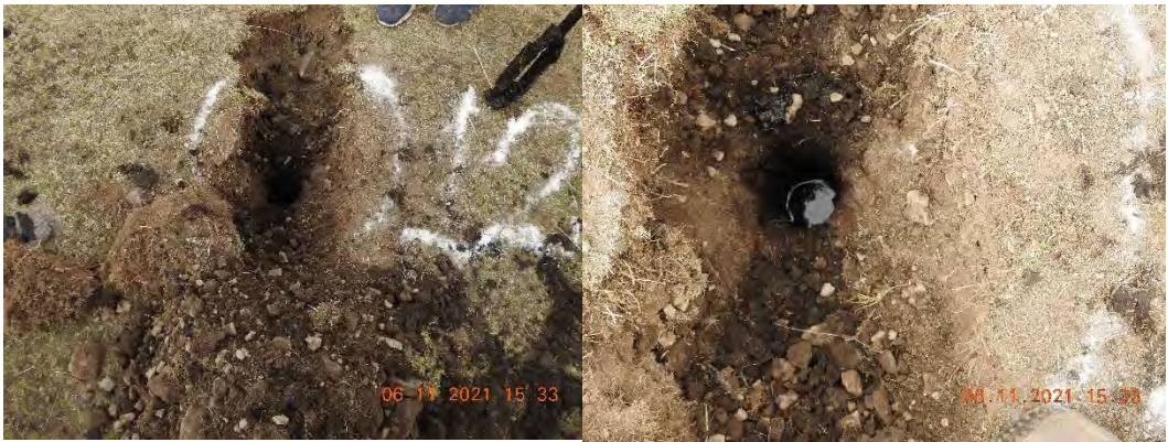
Figura 45. Pozos de la zona norte de la laguna con el ascenso rápido del nivel freático
