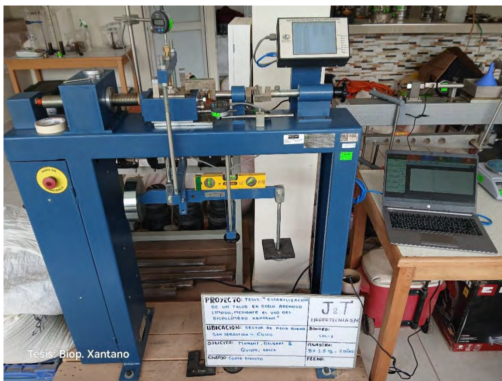
Ensayo de corte directo del suelo natural y suelo modificado con diferentes adiciones del biopolímero xantano, para determinar la cohesión y el ángulo de fricción
