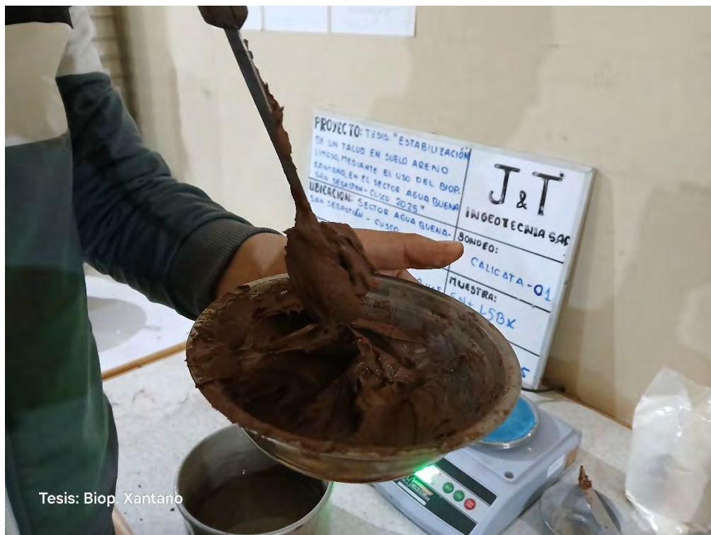
Comportamiento del suelo cuando está modificado con el aditivo, presenta una masa de gel-viscosa, con fuerte enlaces propios del aditivo al ser hidratado con el agua.
