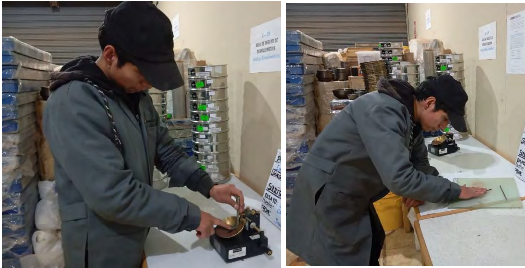
Ensayo límites de consistencia del suelo natural y suelo modificado con diferentes adiciones del biopolímero xantano, para determinar el límite líquido, plástico e índice de plasticidad
