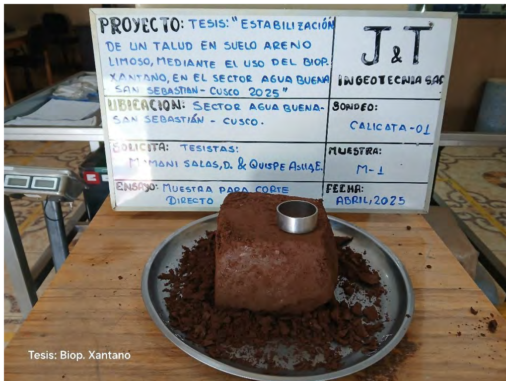
Tallado de la muestra para el ensayo de corte directo de la muestra natural
