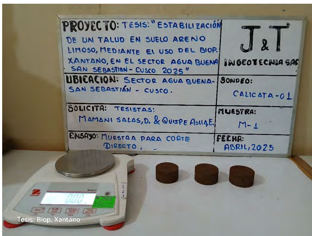
Moldeado de tres (03) especímenes para el ensayo del corte directo para la muestra natural
