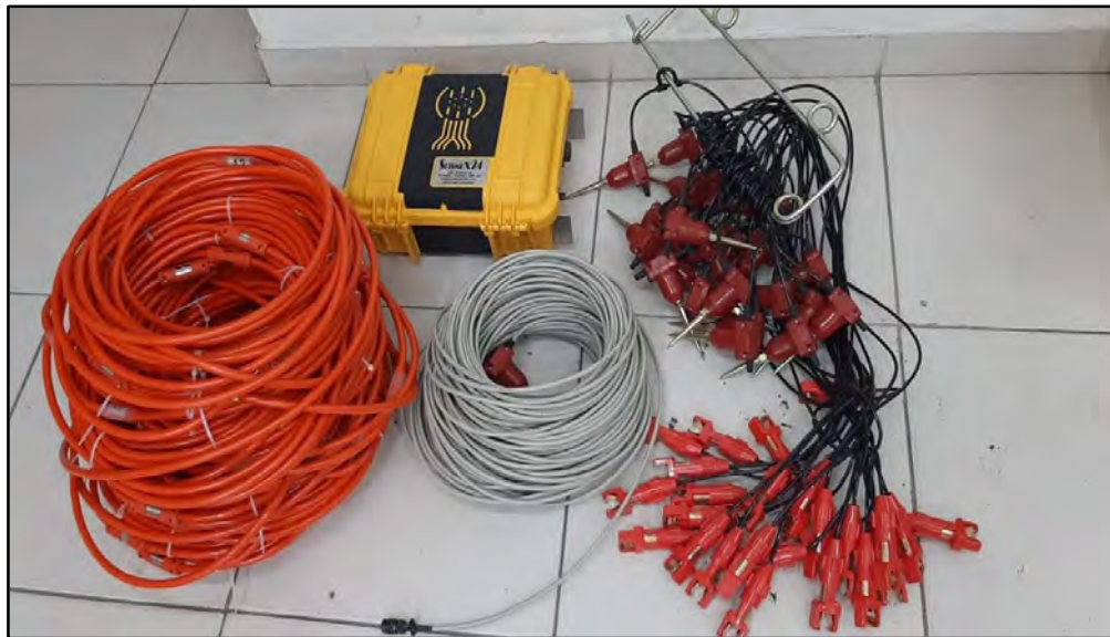
Figura 36. Equipo empleado para el ensayo de Refracción Sísmica.
