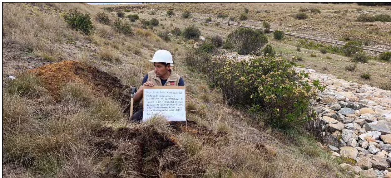
Figura 55. Apertura de calicata C-03 en el espaldón de la presa.
