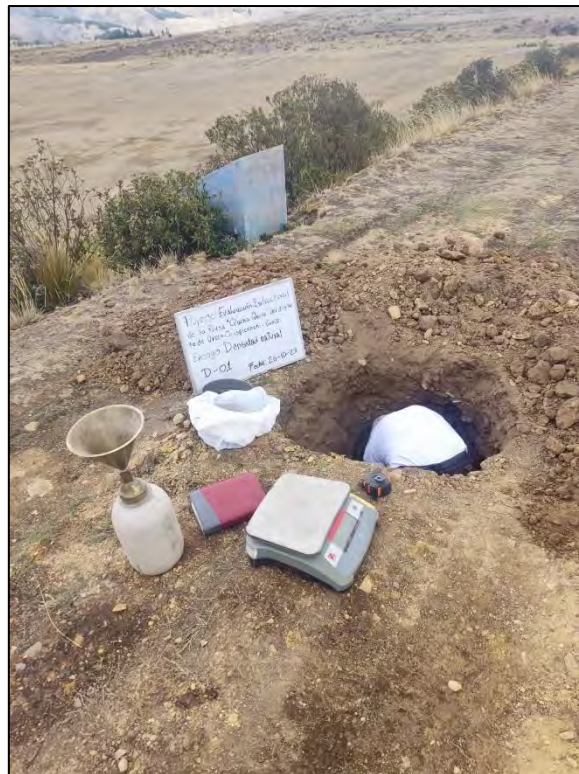
Figura 61. Ensayo de densidad campo con el cono de arena.
