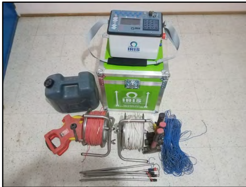
Figura 46. Resistivímetro Syscal pro de la marca Iris Instruments.
