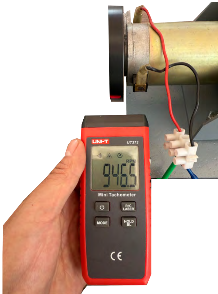
Figura 10.1: Medición de frecuencia de operación con tacómetro digital.
