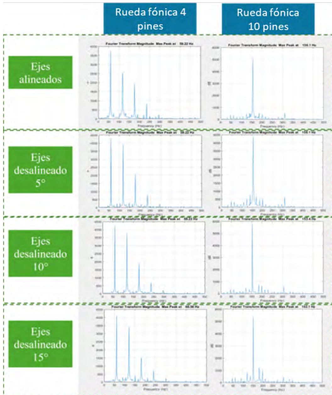
Figura 11.2: Comparación espectral mediante FFT de las señales obtenidas con rueda fónica de 4 y 10 pines, considerando condiciones de eje alineado y desalineamientos angulares de 5°, 10° y 15°.
