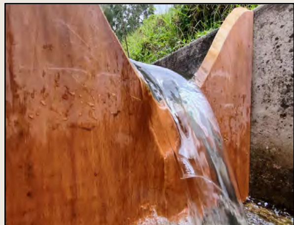
Vertedero en campo
