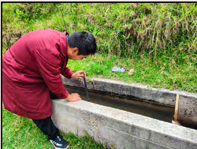
Obtención de la carga de agua
