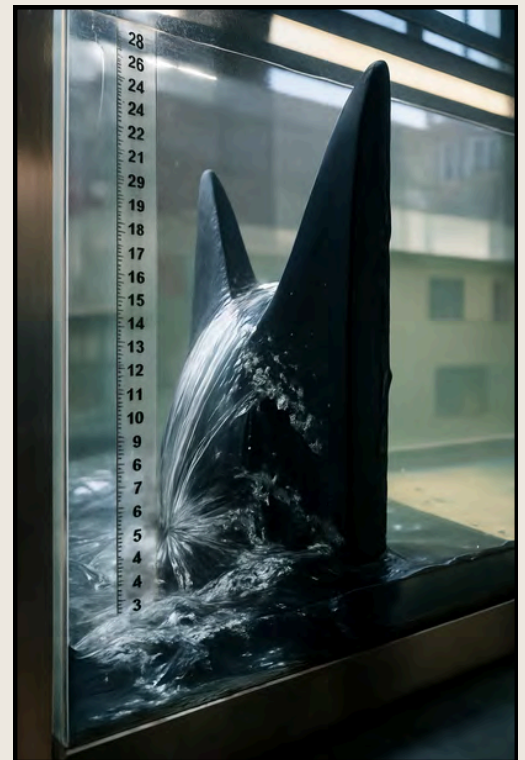
Vertedero utilizado en un canal de laboratorio
