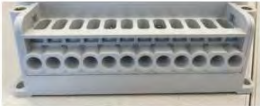
Figura 4-18 Terminales auxiliares de concentrador.
