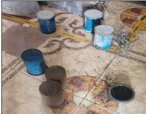
Figura 160. Desencofrado de especímenes a los 28 días
