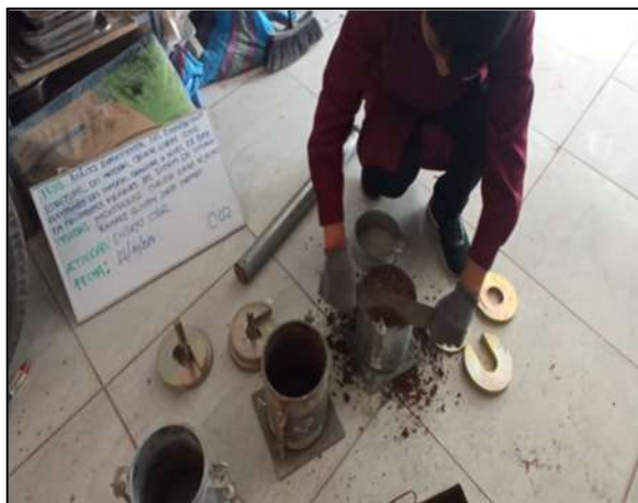
Figura 144. Enrase de muestra para CBR
