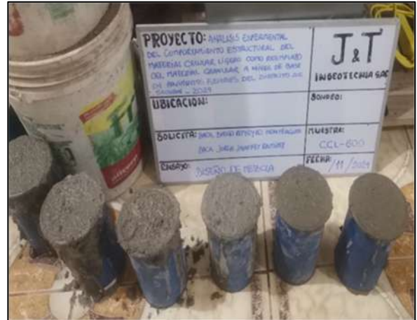
Figura 159. Especímenes en probetas de 4"x 8"
