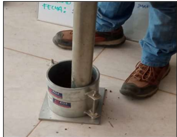
Figura 135. Compactación de muestra con el martillo
