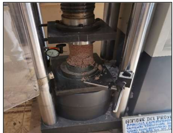
Figura 163. Ensayo de compresión con deformímetros
