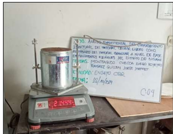
Figura 145. Peso de muestra y molde de CBR
