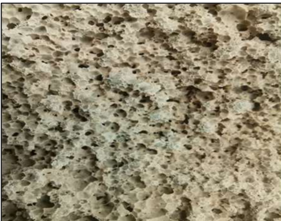
Figura 168. Composición interna MCL \rho = 400\text{kg/m}^3
