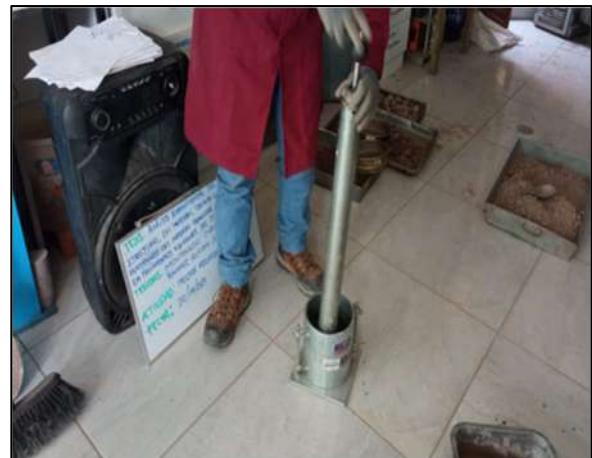
Figura 139. Compactación de muestra por capas
