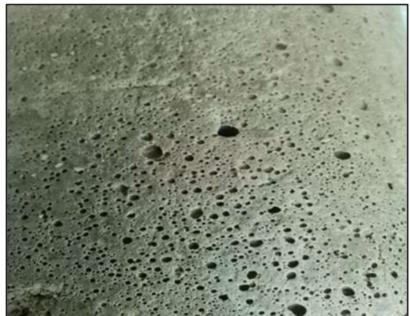
Figura 169. Composición interna MCL \rho = 800\text{kg/m}^3
