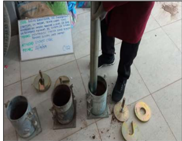
Figura 143. Compactación de muestras con martillo
