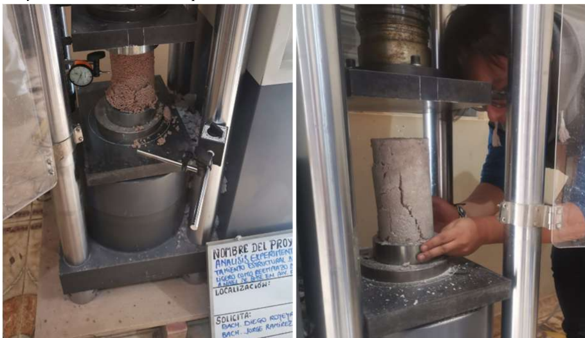
Ensayo de resistencia a la compresión del MCL
