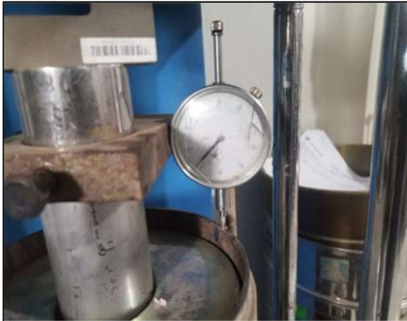
Figura 152. Deformímetro en el ensayo de penetración
