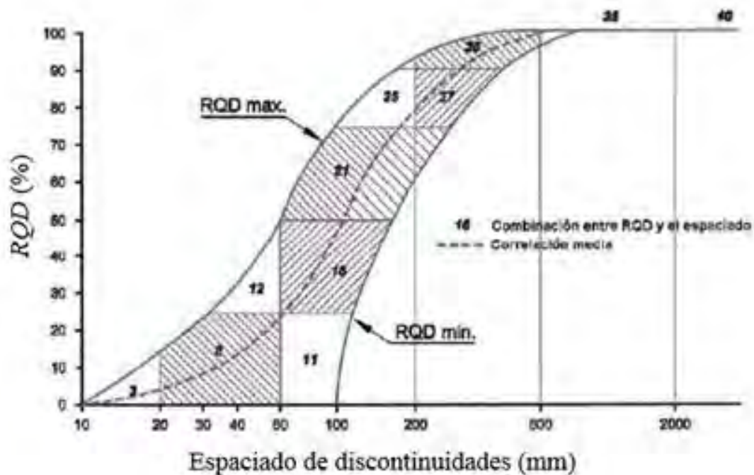
Figura 17: Relación entre espaciamiento de discontinuidad y RQD.
