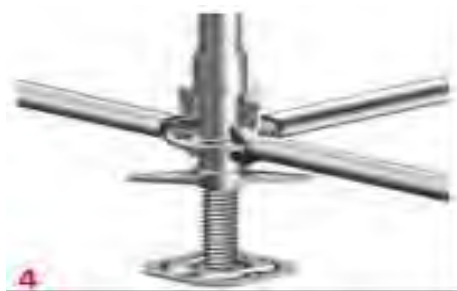
FIGURA 04 – Colocación de verticales
