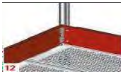
FIGURA 12 – Colocación de rodapiés
