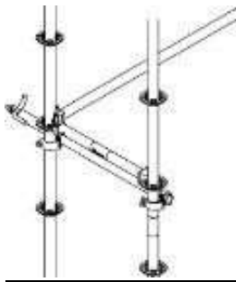
FIGURA 16 – Desmontaje de brazos horizontales superiores
