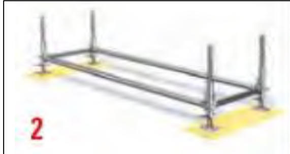
FIGURA 02 – Colocación de base de andamio
