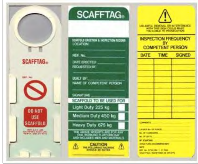
FIGURA 17 – Rotulado de Andamios
