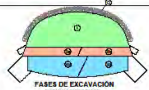
FASES DE EXCAVACIÓN DISTANCIA ENTRE FASES: MÍNIMO I-II : 5m / II-III : 3m / III-IV : 20m / III-IV:10m
