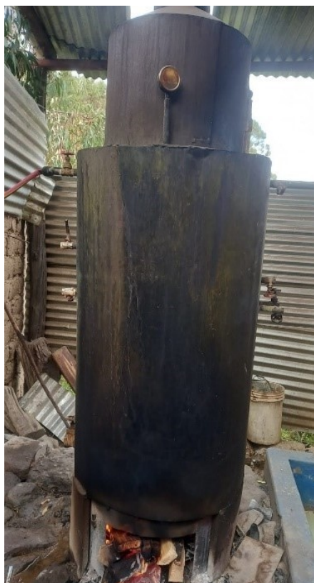
Foto N°04: Caldero de pasteurización para quesos Planta quesera Delis, Lauramarca-Ocongata
