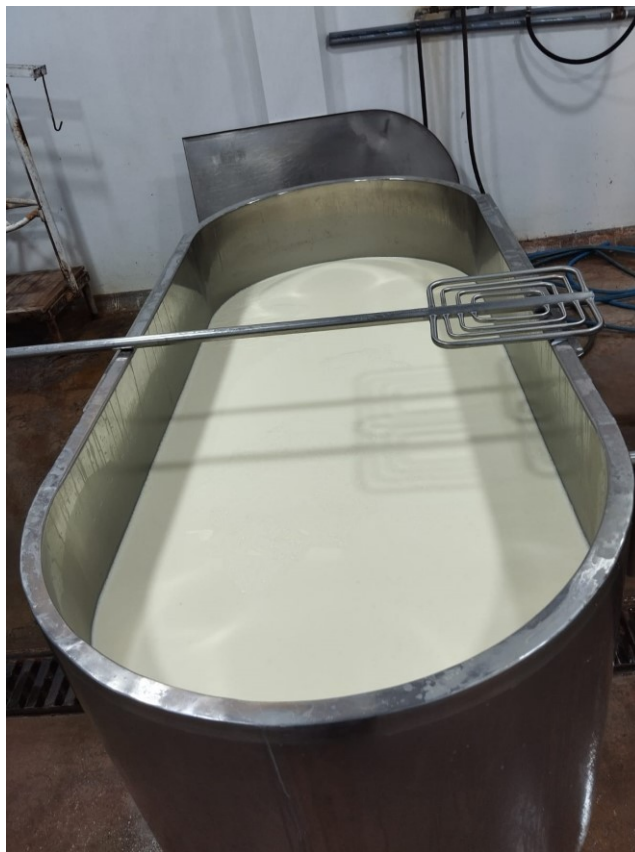
Foto N°5: Cuajado en reposo para corte horizontal y vertical en cuadrículas planta quesera Del Ande- Yanama-Ocongate
