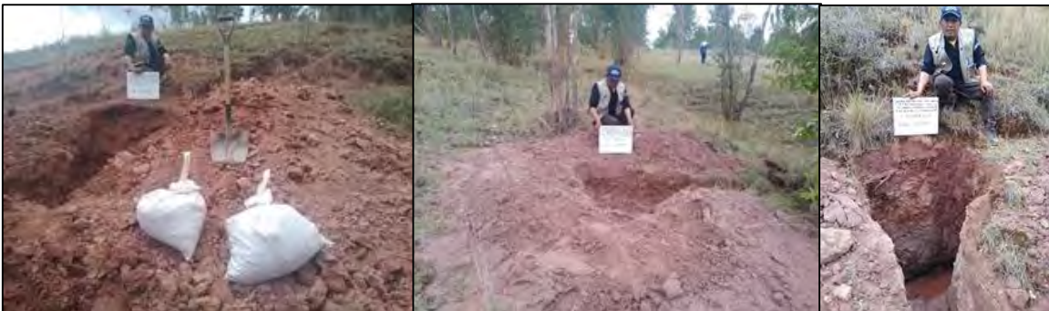
Fotos 3, 4 y 5. Calicatas excavadas manualmente en los puntos definidos de acuerdo al mapeo geológico y muestreo de las mismas.
