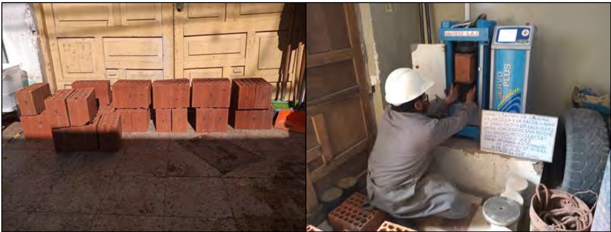
Fotos 28 y 29. De izquierda a derecha se aprecia ladrillos Blocker 12 seleccionados y codificados para realizar ensayo de compresión simple y colocado de ladrillo en prensa de compresión para ejecutar el ensayo.
