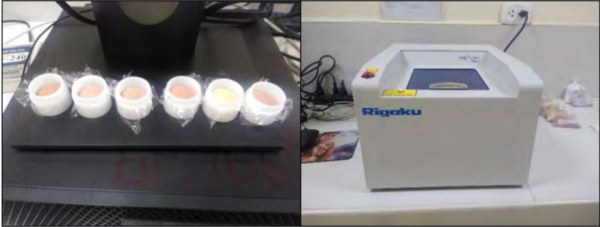
Fotos 10 y 11. Se aprecia de izquierda a derecha muestras preparadas para análisis por Fluorescencia de Rayos X y equipo de Fluorescencia de rayos X con energía dispersiva (Laboratorio LABINVSERV – UNSA – Arequipa).
