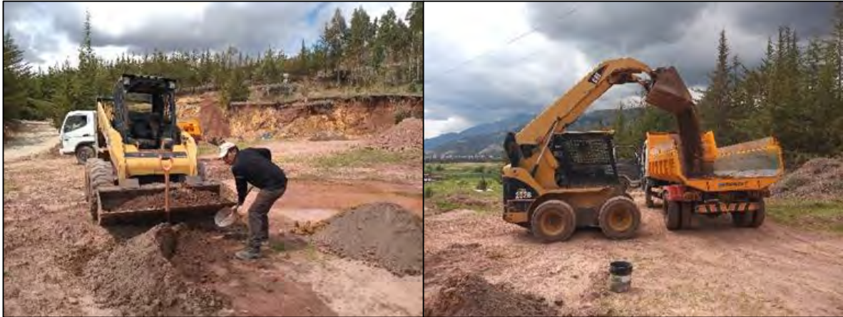
Fotos 22 y 23. Se aprecia de izquierda a derecha minicargador levantando otra mezcla de suelos para ladrillo y descargando en la tolva de volquete que lo llevara a la tolva de la planta de fabricación de ladrillos.
