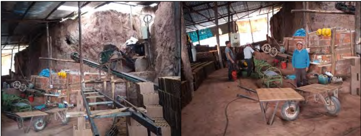
Fotos 24 y 25. De izquierda a derecha se aprecia flujo de producción de ladrillos de arcilla, seguidamente en color verde se observa extrusora con molde de ladrillo Blocker 12.
