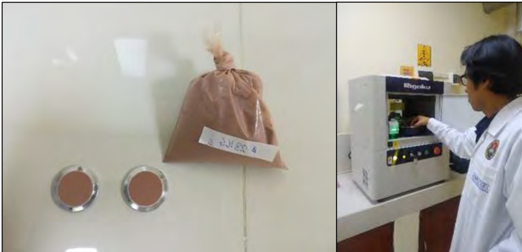
Fotos 12 y 13. Se aprecia de izquierda a derecha muestras preparadas para análisis por difracción de Rayos X y equipo Difractometro de rayos X (Laboratorio LABINVSERV – UNSA – Arequipa).
