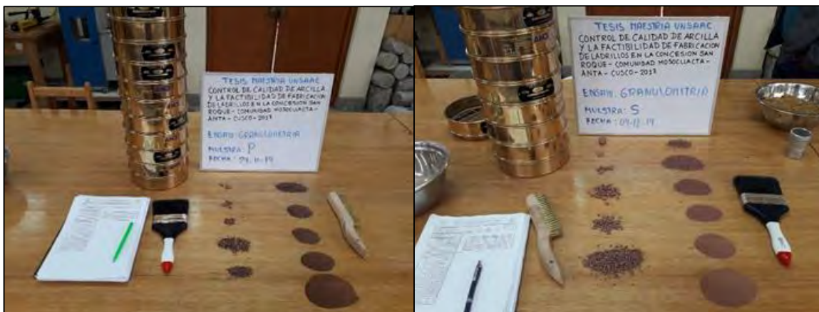
Fotos 14 y 15. Se aprecia de izquierda a derecha ensayo granulométrico por tamizado de suelo arcilloso y ensayo granulométrico por tamizado de suelo limoso.
