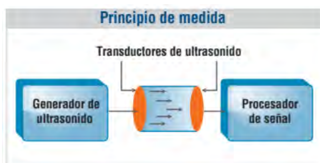
Figura N° 8: Principio de medida LactiCheck
