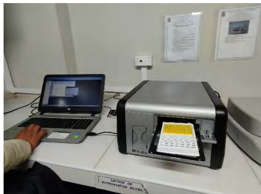
Fotografia N°22: Lectura de los resultados en el lector de microplacas.
