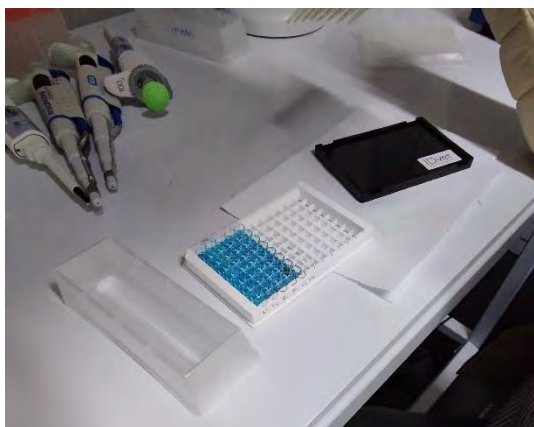
Fotografia N°19: Pocillos despues de la segunda incubacion presentando un color azulado.
