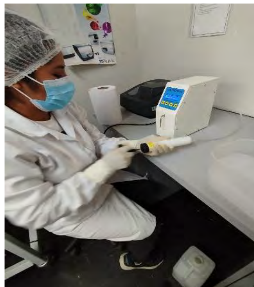
Fotografía N°9: Secado del equipo LactiCheck con un soplete especial y adecuado para el equipo.
