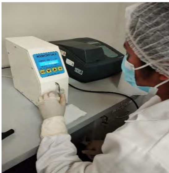
Fotografía N°10: Finalización del uso del equipo LactiCheck lavando cuatro veces con agua destilada hasta su limpieza total.
