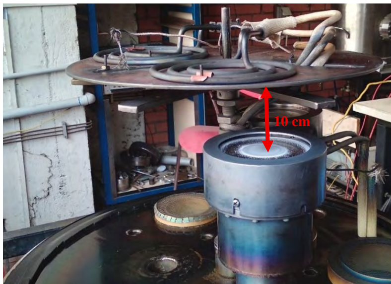
Figura 3.7: Vista fotográfica del plato porta sustrato distanciado aproximadamente a un máximo de 10 cm del blanco de tántalo ubicado sobre el magnetrón.
