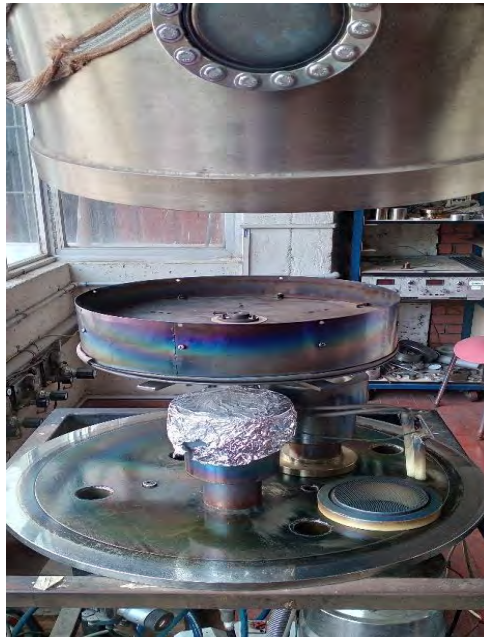
Figura 3.4: Vista fotográfica del sistema magnetrón sputtering con la cámara de vacío descubierta.
