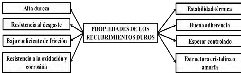
Figura 2.1: Diagrama de las propiedades de los recubrimientos duros (Fuente propia).
