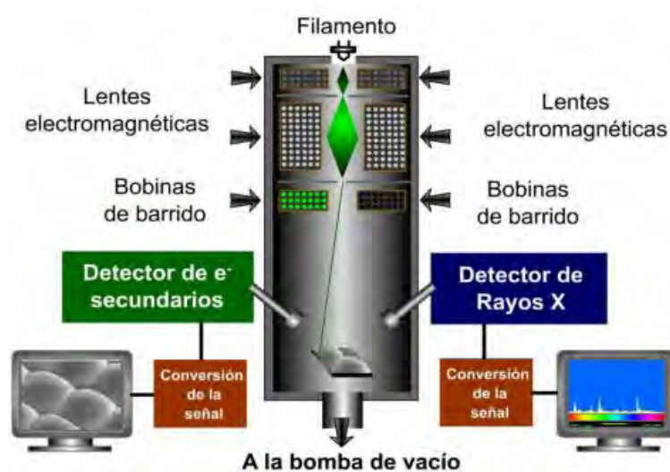
Figura 2.36: Esquema del microscopio electrónico de barrido SEM con detector de rayos X (Meza, 2017).
