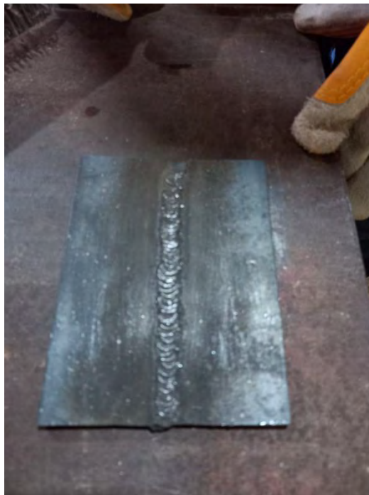
Fotografía 8 Cordón de soldadura después del cepillado
