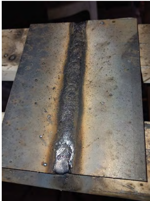
Fotografía 6 Cordón de soldadura de las probetas soldadas
