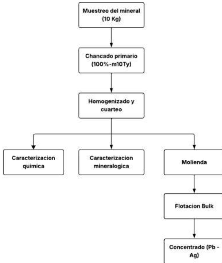
*Nota: Adaptación propia de la descripción del procedimiento experimental a escala laboratorio.*
