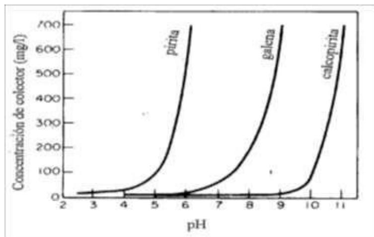
**Nota:** Los valores críticos de pH no solo dependen de la composición del mineral, esto también depende del tipo de colector utilizado de su concentración y de la temperatura (Ballester, Verdeja, & Sancho).
