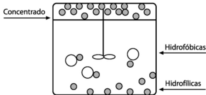
**Nota:** La imagen representa como actúan los minerales hidrofóbicos e hidrofilicos dentro de una celda de flotación. Flotación por concentración en celda (Mineria, s.f.)
