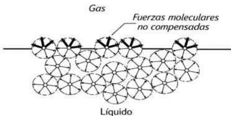
*Nota:* (Sutulov, 1963), mediante la imagen (Figura 10), se puede dar a conocer el origen de las fuerzas moleculares y cómo influyen dentro de la fase G-L del proceso de flotación.
