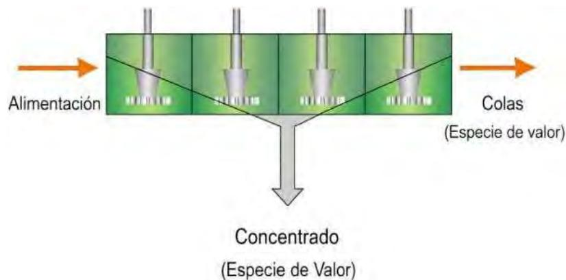
*Nota: Para este tipo de flotación se requiere de una especie que alimente a estas celdas, donde se obtiene un concentrado con un valor. (Zanabria, 2020).*
