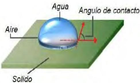
**Nota:** Definición de ángulo de contacto en el proceso de flotación (Huallpa Antoniete, 2018), modificado del libro “Flotación de Minerales” (Sutulov, 1963).
