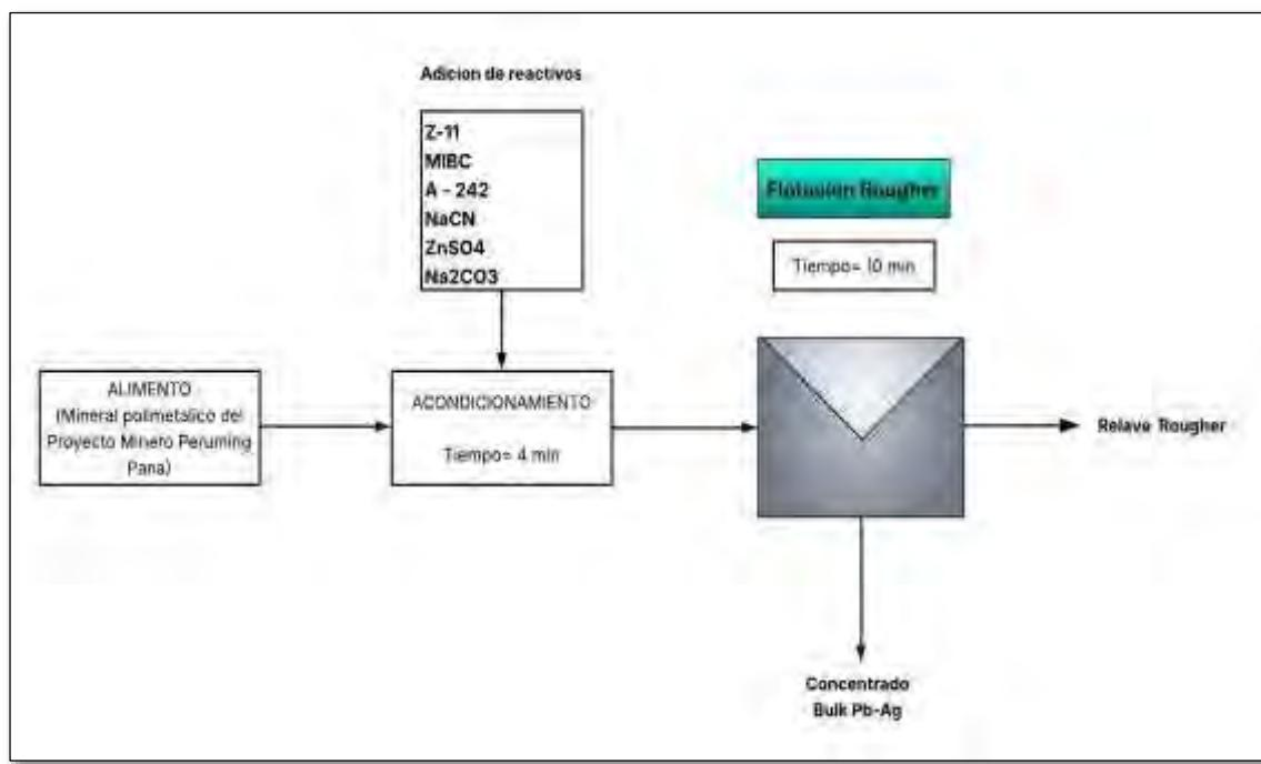
*Nota: Adaptación propia de la Elaboración del Diagrama de Flujo para la realización del proceso de flotación bulk.*
