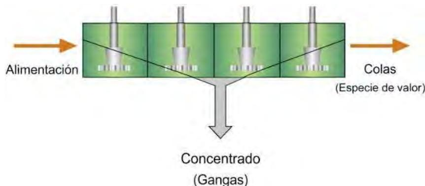
**Nota:** Proceso usado comúnmente cuando se requiere flotar pequeñas cantidades de minerales, esta presenta varias celdas de flotación obteniendo de estas un concentrado. (Zanabria, 2020)
