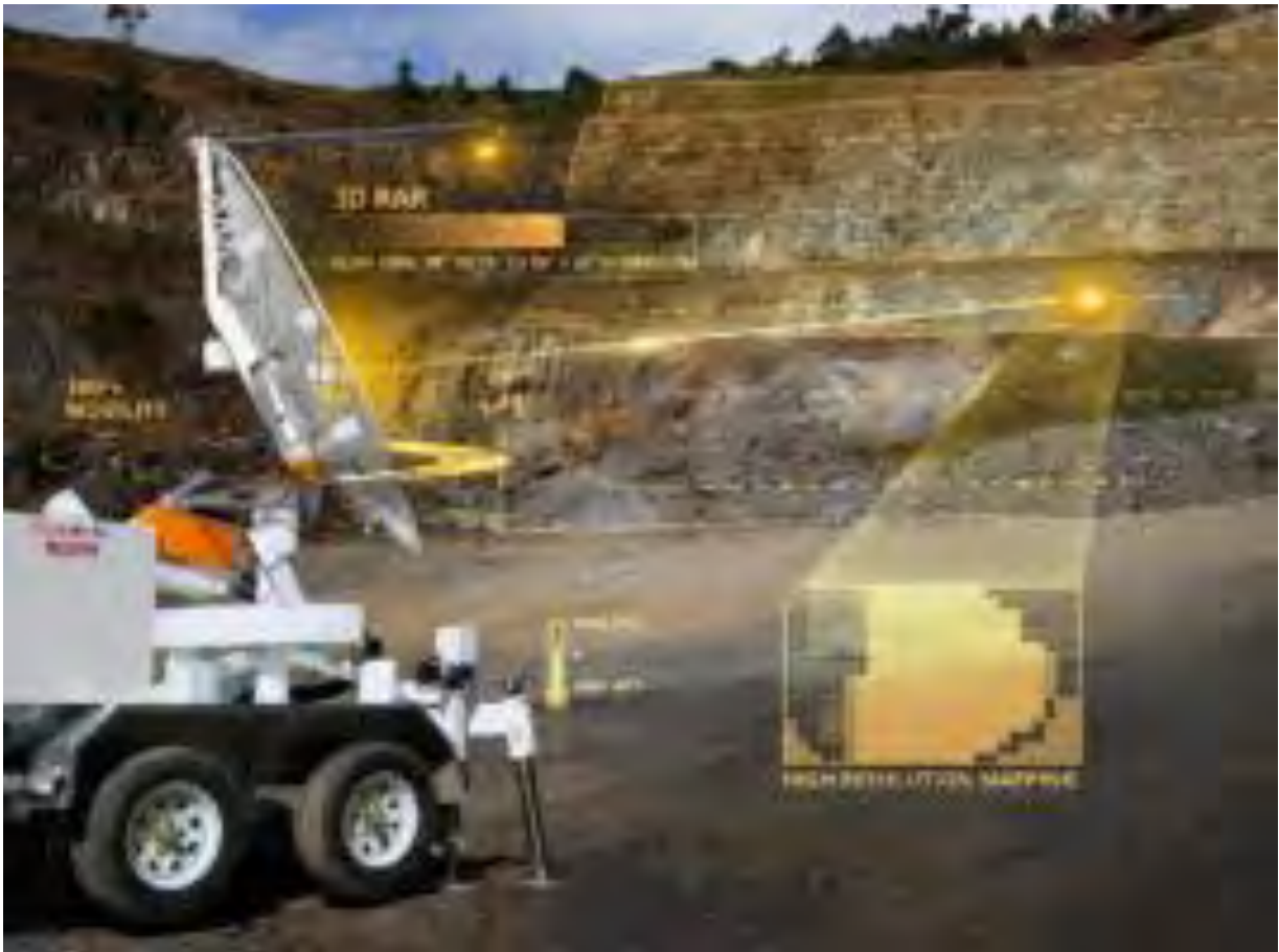
Figura 9. Monitoreo de talud con tecnología RAR
