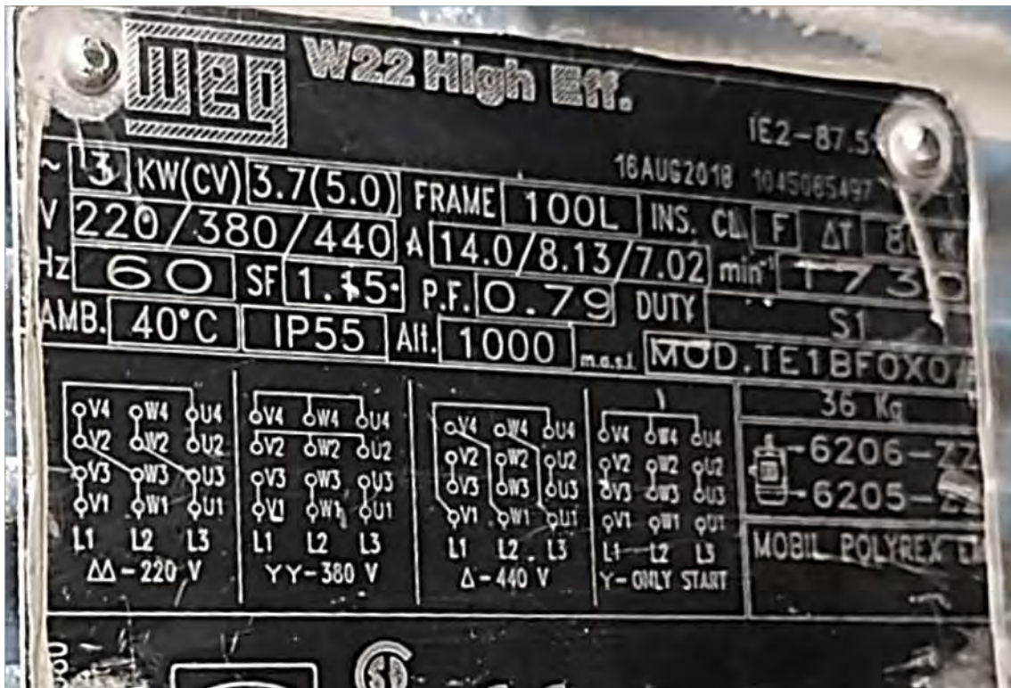
Figura 32 Características de Motor del HPGR
