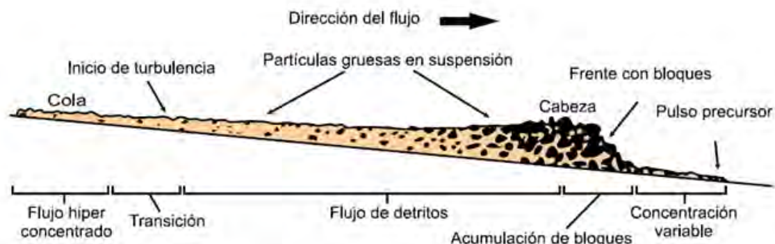
Imagen 8. Diagrama de Pierson (1986) que muestra el corte esquemático típico de un flujo de detritos, mostrando con bloques de un pulso de un flujo (PMA, GCA, 2008)
