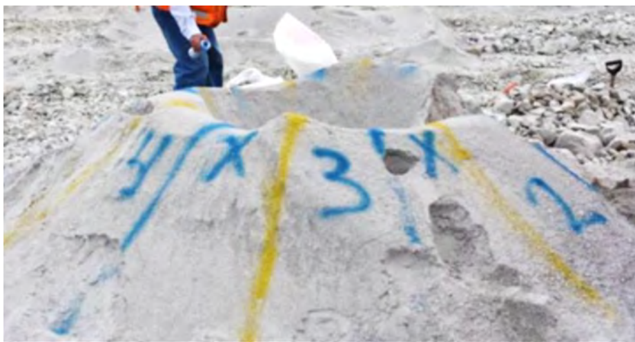
FOTO 34 DIVISIÓN DE SECCIONES EN LOS BLASTHOLES PREVIO A LA EXTRACCIÓN DE MUESTRAS DEL CONO TOTAL
