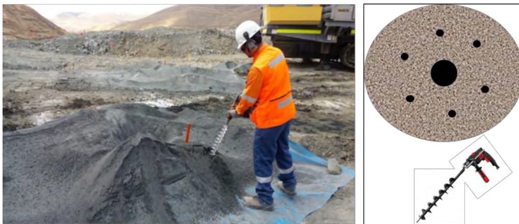
FOTO 31 MUESTREO POR MÉTODO DEL AUGER Y REPRESENTACIÓN ESQUEMÁTICA DE LAS INSERCIONES
