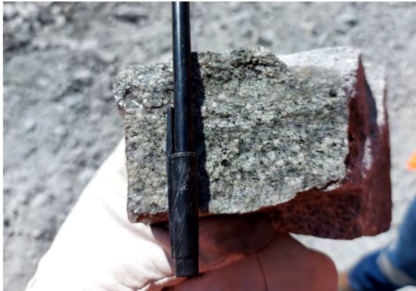
Foto 12 MUESTRA DE MANO DE MONZONITA BIOTÍTICA FINA (MBF), CON ALGUNOS CRISTALES DE BIOTITA Y VENILLAS DE CUARZO
