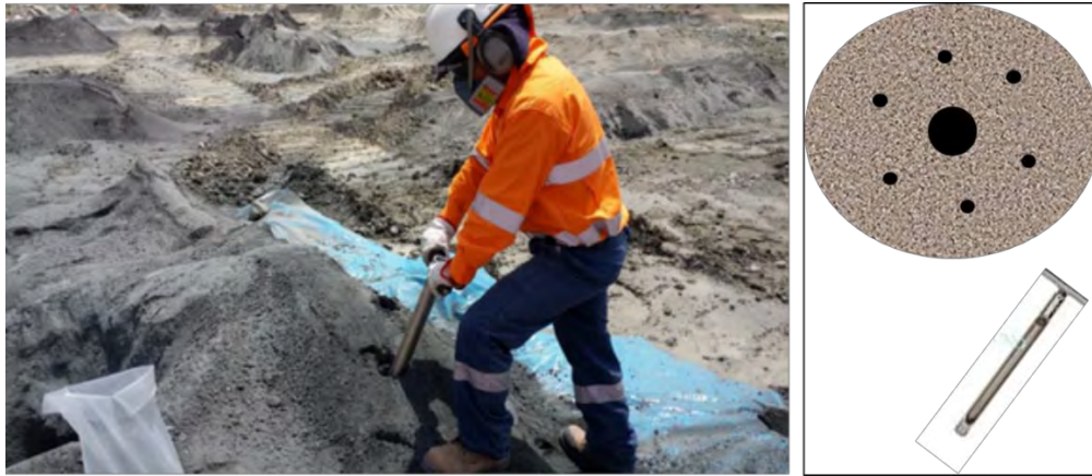
FOTO 32 MUESTREO POR EL MÉTODO DEL TUBO Y REPRESENTACIÓN ESQUEMÁTICA DE LAS INSERCIONES
