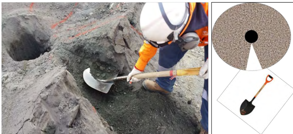
FOTO 33 MUESTREO POR EL MÉTODO DEL CANAL Y REPRESENTACIÓN ESQUEMÁTICA DEL CORTE DE LA SECCIÓN
