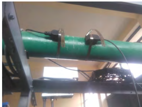
Figura 1. Montaje de los sensores ultrasónicos de caudal. Fuente: elaboración propia.
