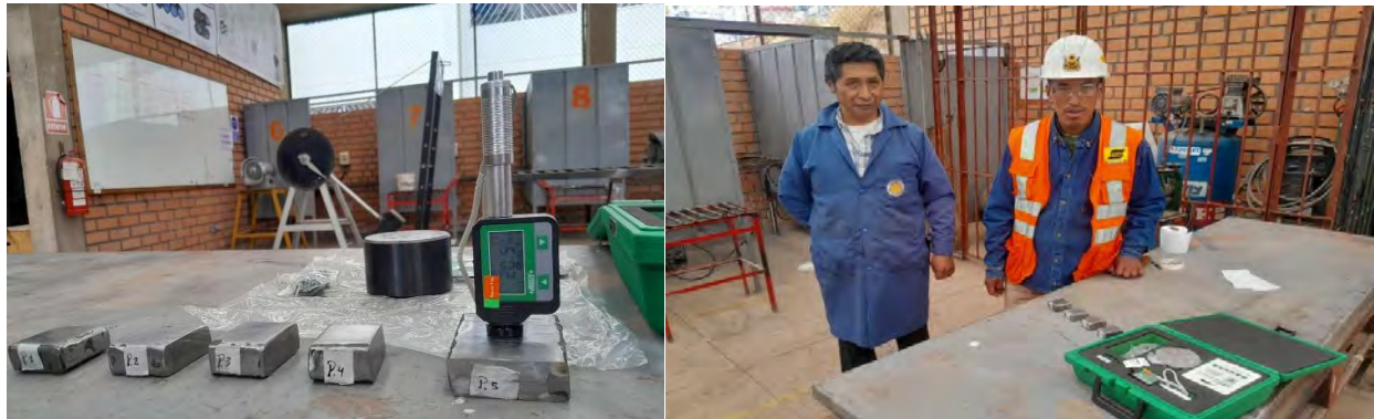
Fotografía de la medición de la dureza con el durómetro digital portátil #HDT-1411 INSIZE
