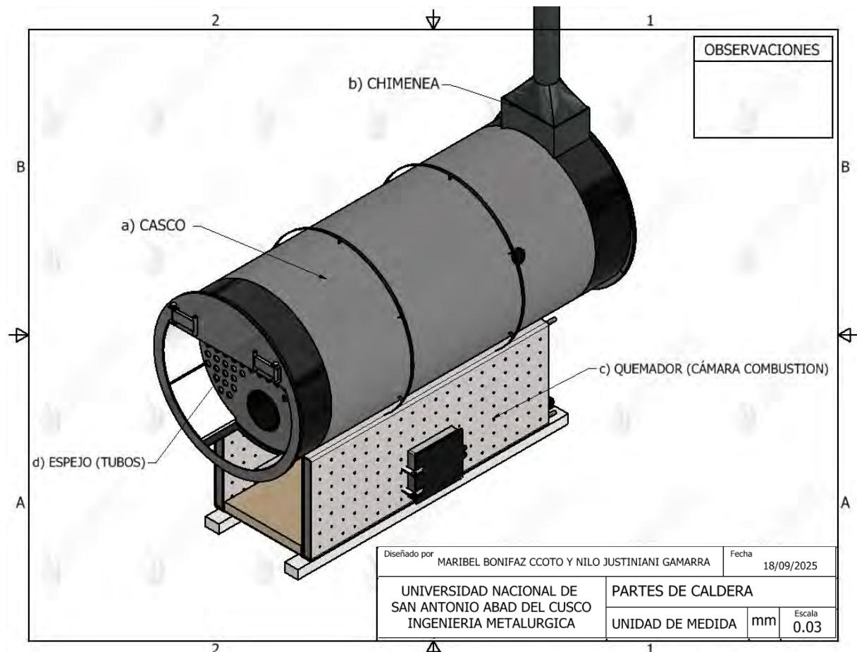
*Nota.* El gráfico representa las partes de una caldera diseñada en la empresa SOLEMAN.
