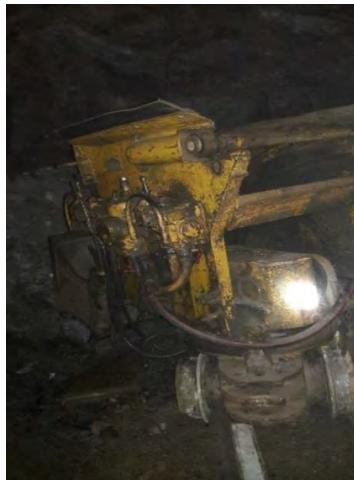
*Nota: En la figura se muestra la limpieza de un frente con pala neumática y el traslado de mineral o desmonte proveniente de los tajos o de los frente des avance (Fuente: Operaciones Mina).*
