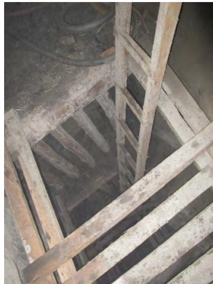
*Nota: el ventilador está brindando aire fresco hacia la galería en ejecución, la chimenea camino buzón sirve dentro del circuito de ventilación natural (Fuente: Operaciones Mina).*
