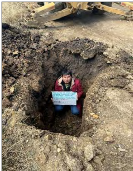
Fotografía N°6 Calicata C-03 Excavación, extracción y estratigrafía
