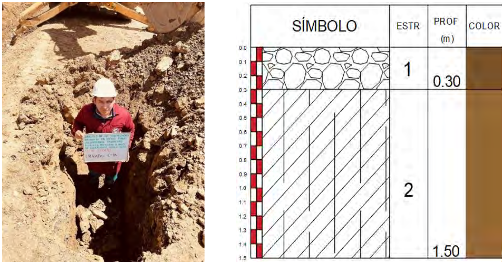
Fotografía N°9 Calicata C-06 Excavación, extracción y estratigrafía
