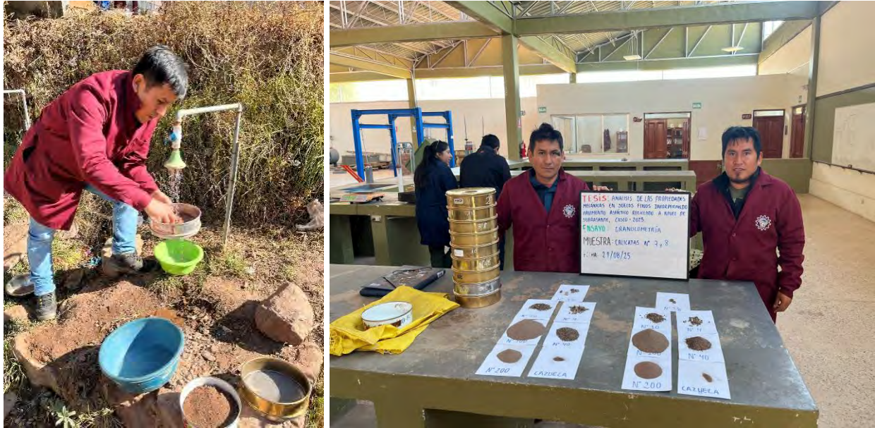
Fotografía N°14 Lavado de material y tamizado de la muestra
