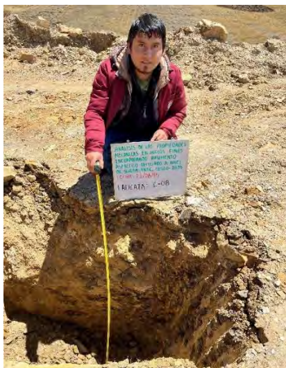
Fotografía N°11 Calicata C-08 Excavación, extracción y estratigrafía
