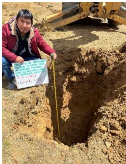
Fotografía N°7 Calicata C-04 Excavación, extracción y estratigrafía
