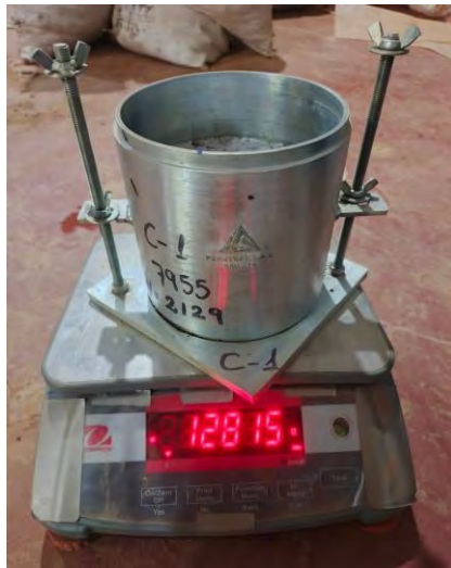
Ensayo de CBR Compactado
