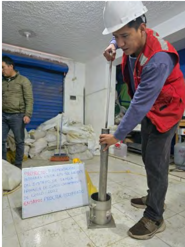
Ensayo de Proctor Modificado
