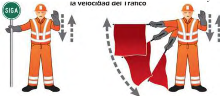
Figura 62. Señales Para alertar y reducir la velocidad del Tráfico
