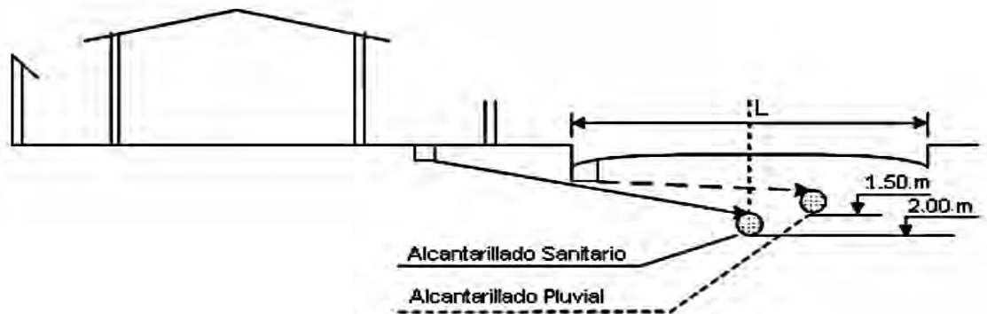
Figura 19. Sistema de drenaje separativo
