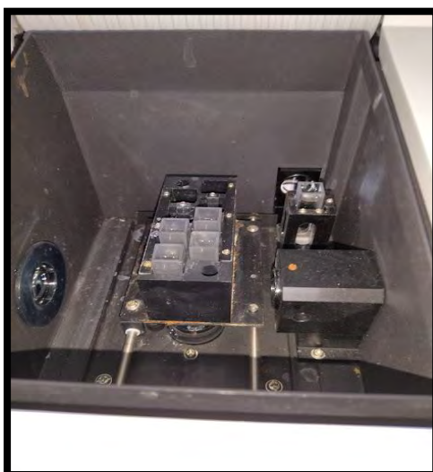
FOTOGRAFÍA N° 31: Se aprecia las muestras obtenidas de la disolución del parche transdérmico en las cubetas del espectrofotómetro.
