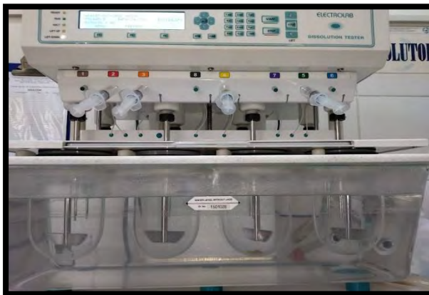
FOTOGRAFÍA N° 30: Se aprecia la aspiración con jeringas de pequeñas alícuotas
