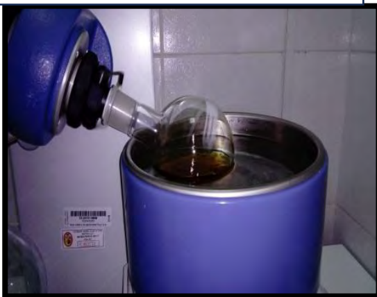
FOTOGRAFÍA N° 8: Extracción del alcohol de la muestra en el equipo del rotavapor.
