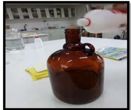
FOTOGRAFÍA N° 5: Maceración de la muestra seca con alcohol al 70%.
