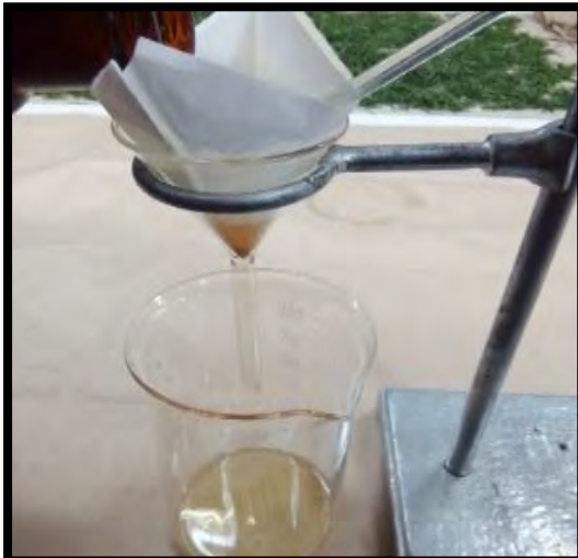
FOTOGRAFÍA N° 6: Filtración del extracto etanolico de Acaulimalva engleriana .
