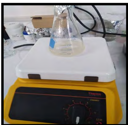
FOTOGRAFÍA N° 25: En la imagen se aprecia trozos de parche que se colocaron en un matraz volumétrico de 100mL, se añadió 50mL de disolución tampón de fosfato (pH 7.4) y se conservó en un agitador por el tiempo de 12 horas, para luego determinar el contenido del fármaco.
