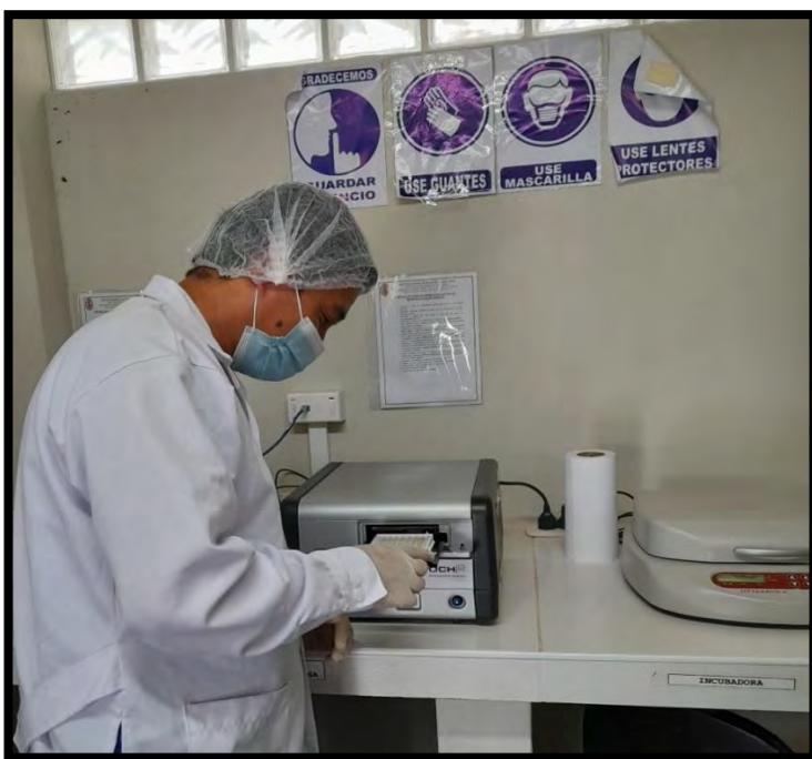
Figura 19. Lectura de las absorbancias de las muestras por espectrofotometría.
