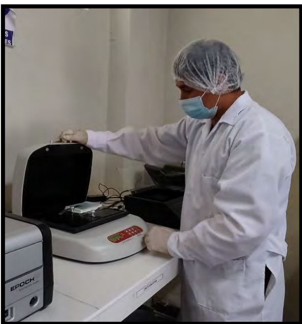
Figura 13. Primera incubación de la placa ELISA a 26°C por una hora.
