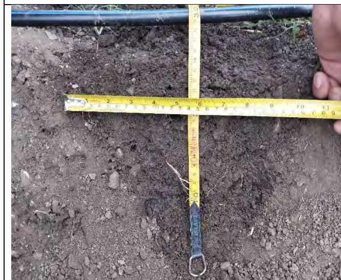
Fotografía: Bulbo húmedo con lamina de riego de 70% en 45 minutos.
