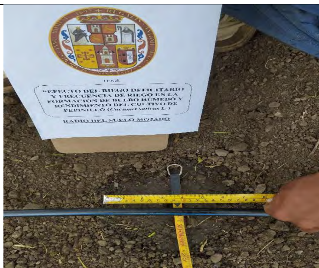
Fotografía: Bulbo húmedo con lamina de riego de 60% en 45 minutos.
