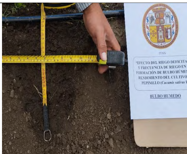
Fotografía: Bulbo húmedo con lamina de riego de 80% en 45 minutos.
