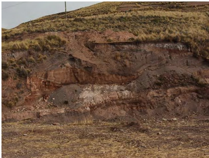
Foto 8: Se aprecia los depósitos lacustres en este corte donde se ve niveles de diatomitas impuras intercaladas con capas de limos, arcillas y arena Km 29+000
