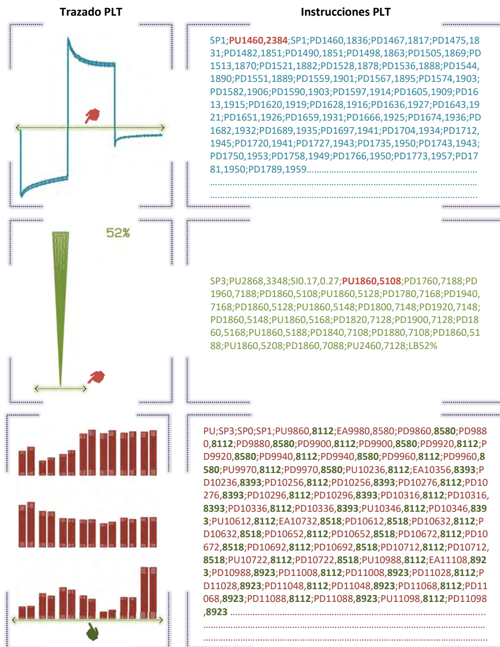
Figura 52 Mapecto de los Trazados en Instrucciones HP-GL
