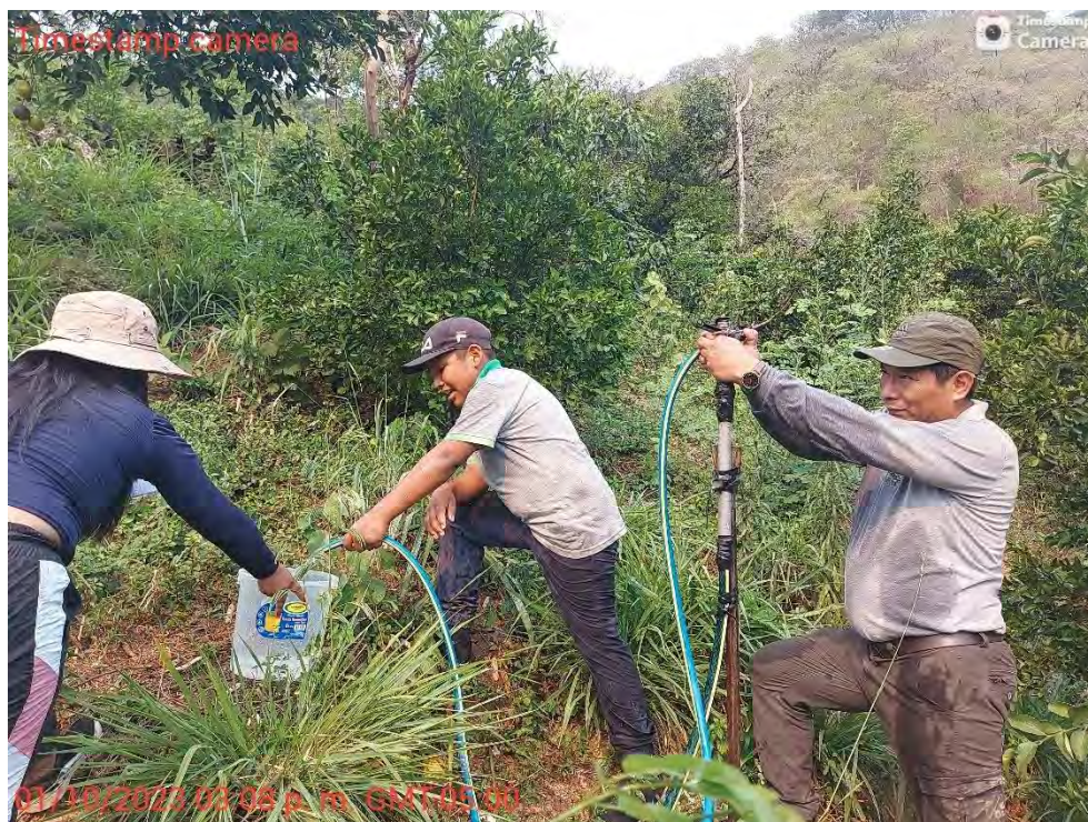
Fotografía 5. Medida de caudal de aspersor VYR 35.
