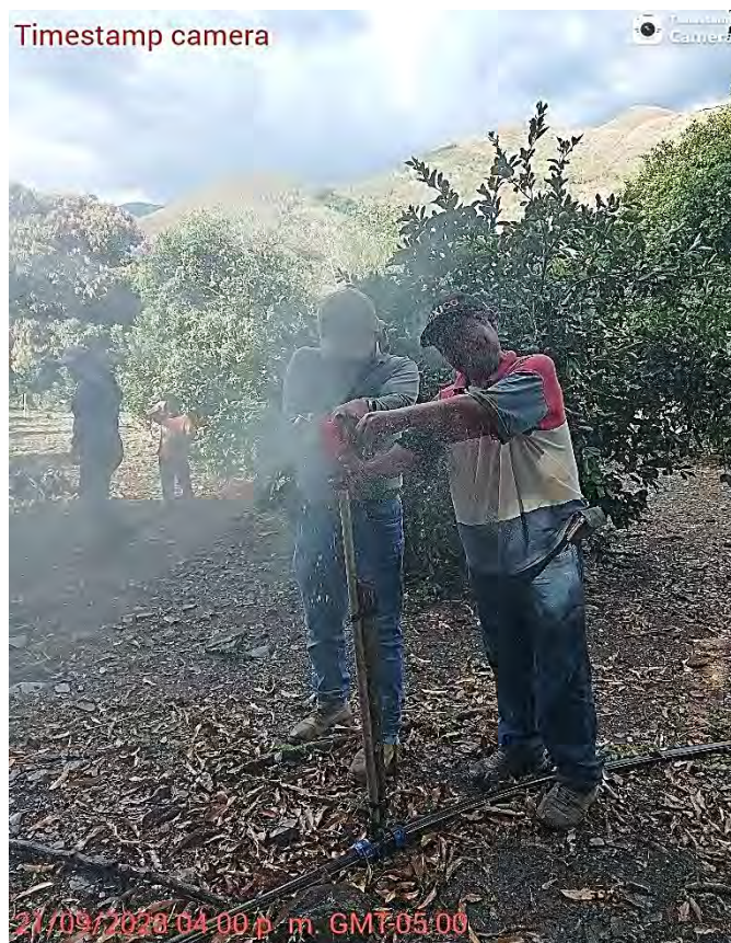
Fotografía 4. Medida de presión con manómetro del aspersor K30.
