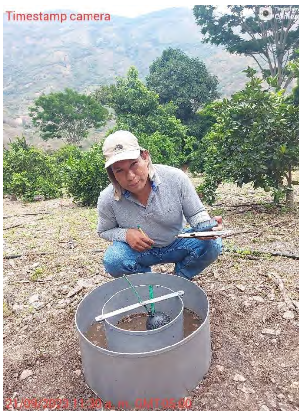
Fotografía 7. Evaluación de la velocidad de infiltración con infiltrómetro de doble cilindro.
