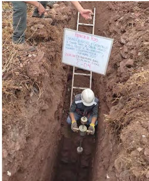
Existen correlaciones para determinar el valor "N<sub>60</sub>" de resistencia a la penetración estándar (SPT) en función del tipo de suelo por cada 30 cm de hincado. De esta correlación se obtiene el perfil de tipo de suelo según la norma técnica E.030 "Diseño Sismorresistente", constatando que sectores de las calicatas C-03, C-04, C-05 y C-06 son suelos Blandos (S3) y los sectores C-01, C-02 y C-07 son suelos blandos (S3) e Intermedios (S2).
