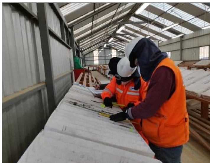
Figura 10: Registro Geomecánico de la masa rocosa en sondajes diamantinos
