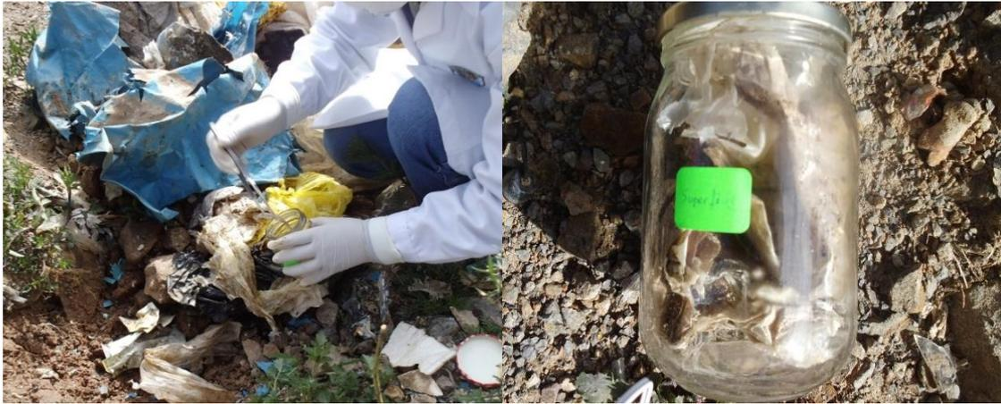
**Foto 4.** Proceso de muestreo en superficie de bolsas de plástico con signos de deterioro.
