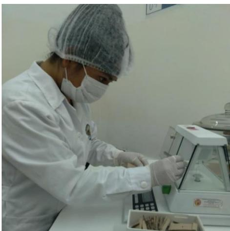
**Foto14.** Calibración de la Ultramicrobalanza.
