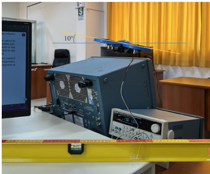
*Nota.* La línea azul es paralela al nivel que se encuentra en la superficie de referencia. La línea amarilla entrecortada representa a la variación en pitch del VANT, producido por el sistema de control diseñado. La estructura del VANT está siendo sujeta a un soporte mediante el uso de una cuerda, para limitar su área de maniobras.
