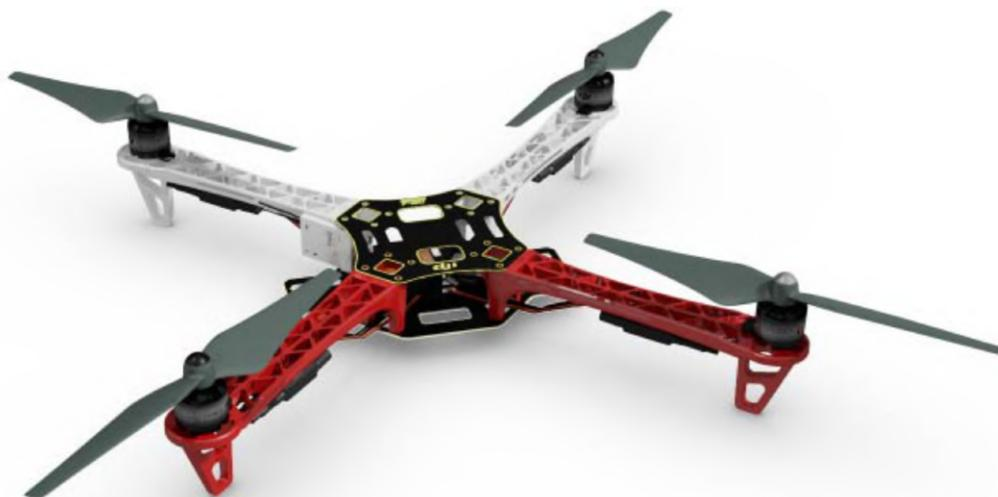
*Nota.* Estructura modular de un vehículo aéreo no tripulado de la marca DJI, modelo: F450. Los motores y las hélices son referenciales. Adaptado de (DJI Innovations, 2023).
