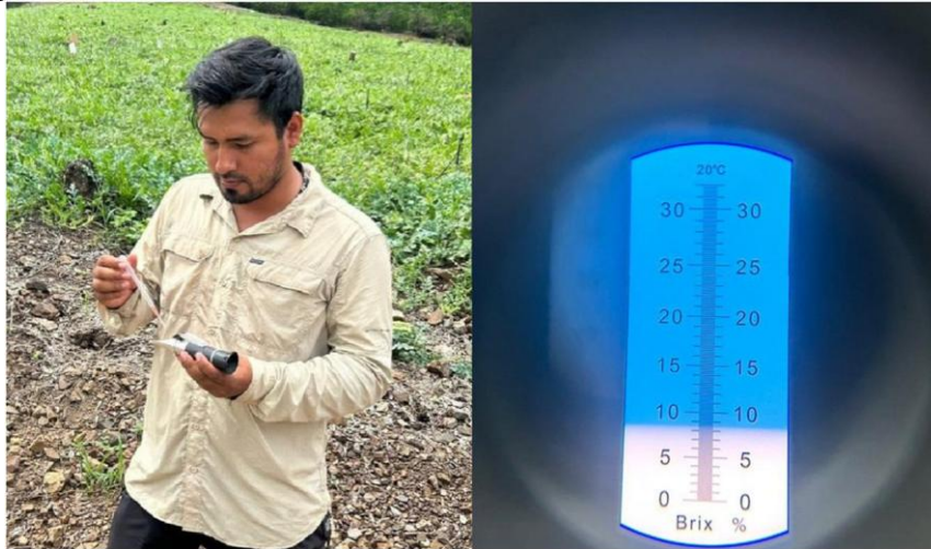
Fotografía 10: Lectura del contenido de sólidos solubles en el refractómetro
