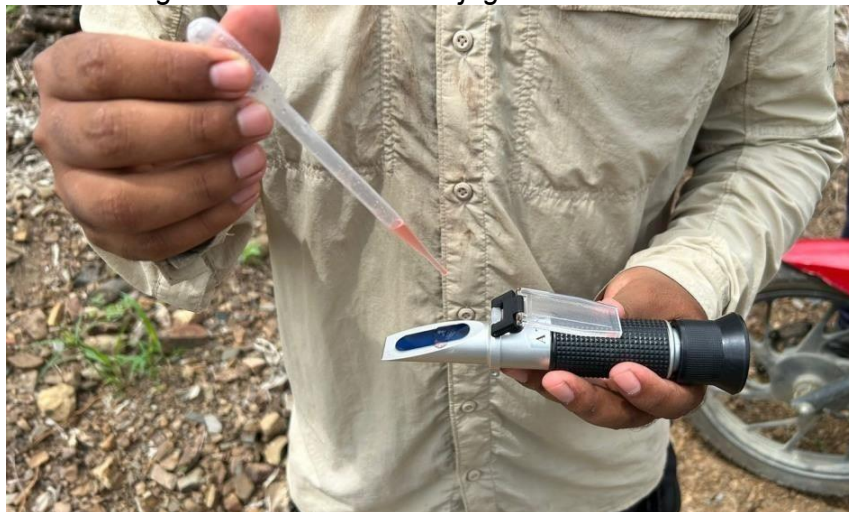
Fotografía 9: Colocando el jugo en el refractómetro
