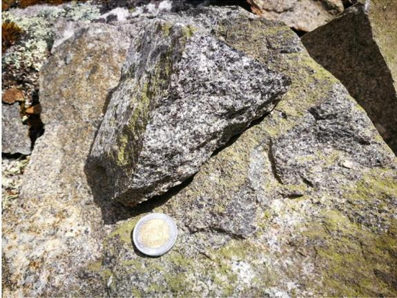
Para la identificación del tipo de roca, se basa en las clasificaciones de campo en base a minerales esenciales visibles con la ayuda de una lupa de 20x de aumento (Figura 28), teniendo como resultado cuarzodiorita.
