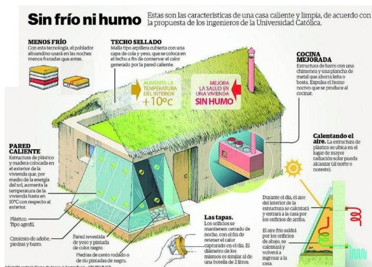
*Nota.* Se muestra la aplicación del muro trombe. Adaptado de diario el correo. <https://diariocorreo.pe/peru/los-muros-trombe-el-calefactor-natural-de-la-vivienda-andina/>
