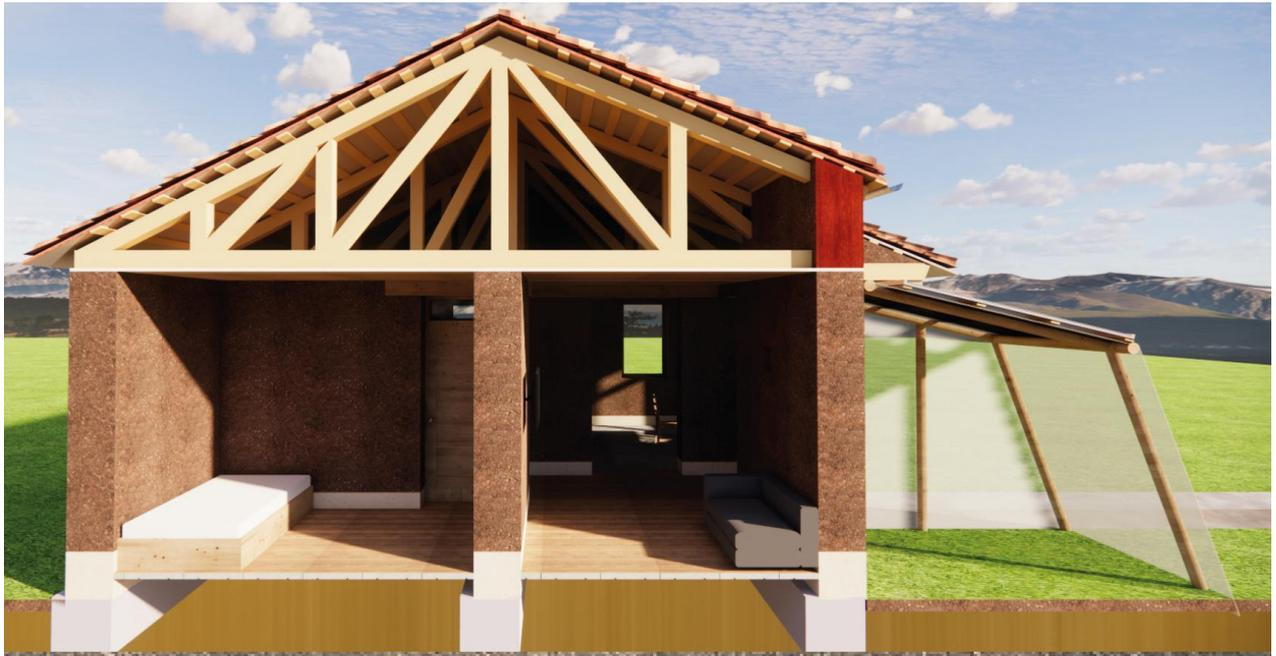
*Nota.* Se muestra un corte transversal de la propuesta arquitectónica, la ubicación de uno de los dormitorios y la sala, se observa que el muro trombe está ubicado en directamente a la sala.
