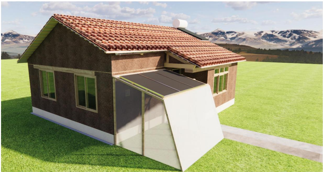
*Nota.* Se muestra la vista isométrica de la propuesta arquitectónica de la vivienda se puede apreciar la cámara de aire el cual calentará el muro trombe y consecuentemente por convección al interior de la vivienda.
