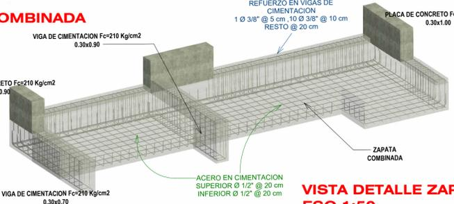
**VISTA DETALLE ZAPATA COMBINADA ESC 1:50**
