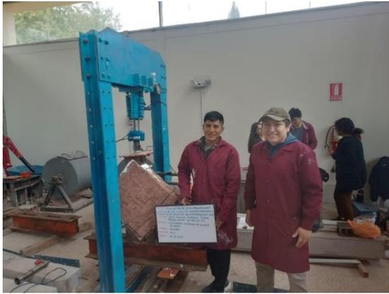
**Figura 58.** Colocación de muretes de adobe para ensayo de compresión diagonal.
