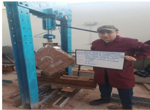
**Figura 61.** Ensayo de compresión diagonal o tracción directa de muretes número 02.
