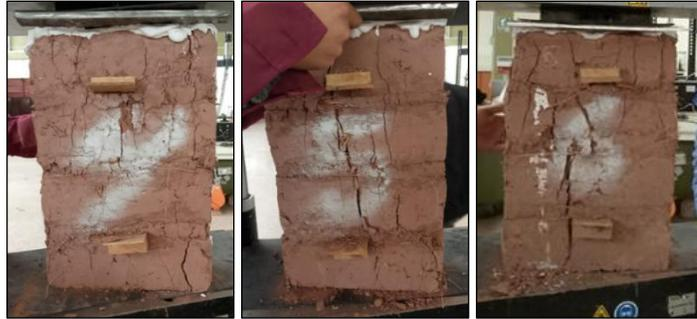
*Nota. Se observa la falla de las 6 pilas después del ensayo axial en la máquina universal.*
