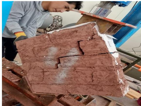
**Figura 63.** Falla por agrietamiento diagonal de Murete 04 luego del ensayo de compresión diagonal
