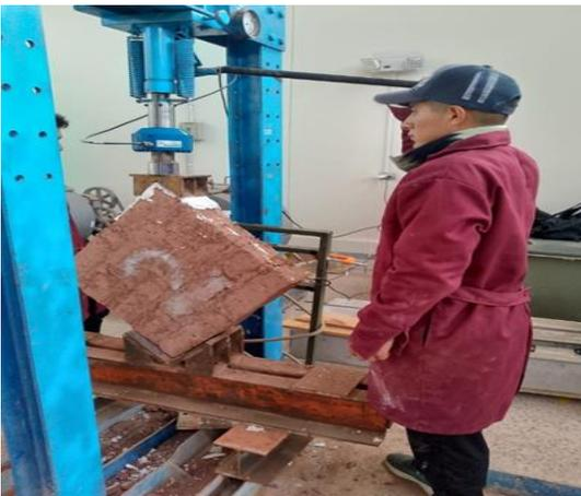
**Figura 62.** Proceso de ensayo de compresión diagonal o tracción directa de muretes
