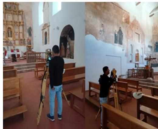
**Fotografía 15:** Levantamiento geométrico de la geometría en planta y elevación de las iglesias parte interior.
