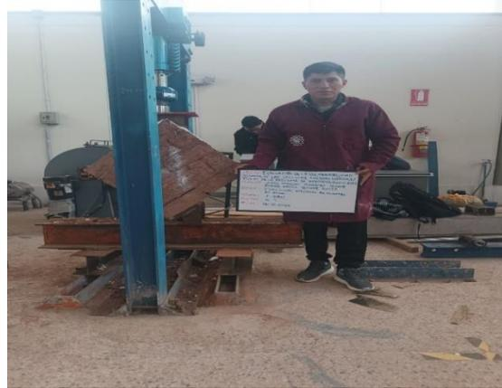
**Figura 59.** Ensayo de compresión diagonal o tracción directa de muretes número 04.
