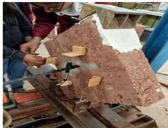
**Figura 57.** Instrumentación y colocación de Diales de deformación para ensayo de compresión diagonal.
