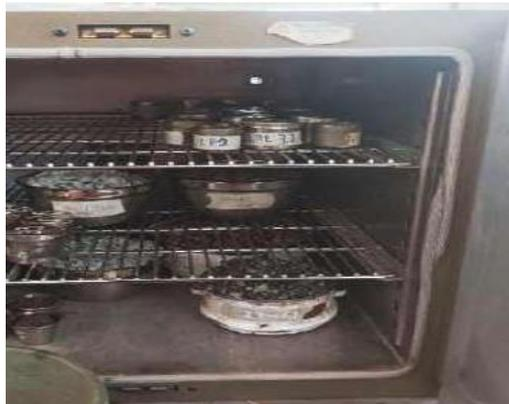
**Fotografía 38:** Secado de las muestras en el horno
