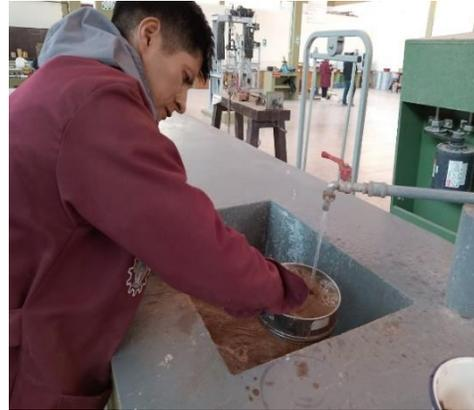
**Fotografía 29:** Lavado de muestra de suelo para la realización de ensayo de granulometría.
