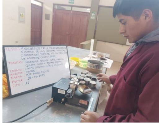
**Fotografía 35:** Realización de ensayo de límite Liquito del adobe y mortero.
