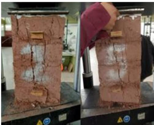
**Figura 56.** Formas de falla por agrietamiento vertical en pilas de adobe
