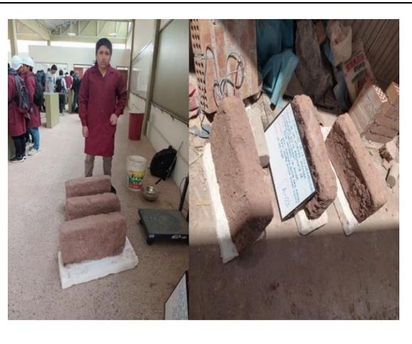
**Fotografía 17:** Medición de peso de muestras de adobes en el laboratorio de FIC.
