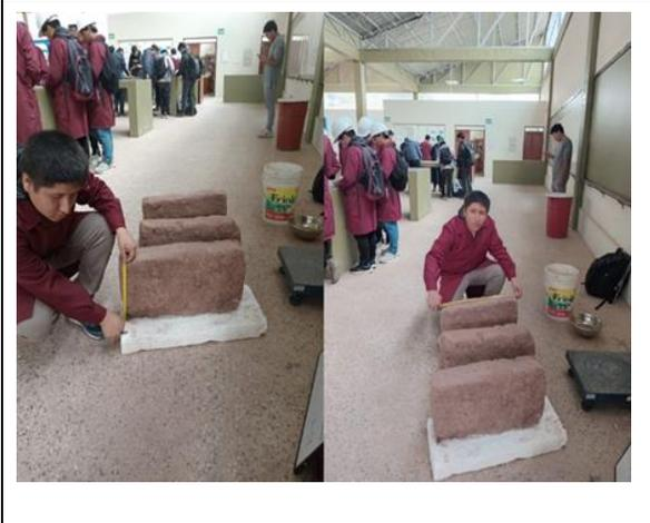
**Fotografía 18:** Medición de muestras de adobes en el laboratorio de la FIC.
