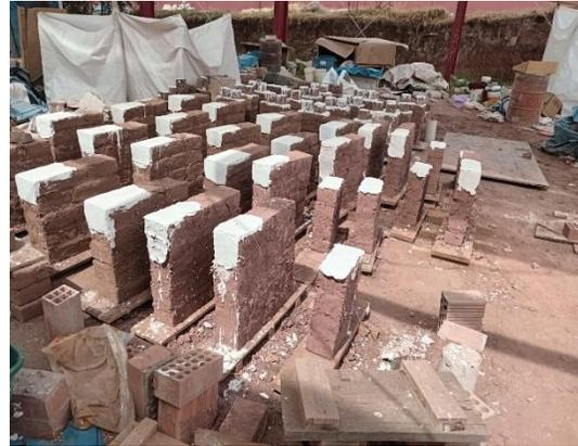
**Fotografía 53:** Secado y tendido de pilas y muretes de mampostería de adobe.
