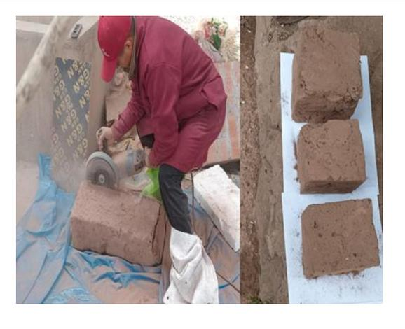
**Fotografía 19:** Elaboración y tallado de especímenes en forma de cubo de adobes extraídos con ayuda de amoladora.
