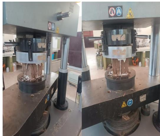
**Fotografía 25:** Falla por agrietamiento vertical en especímenes (cubos) de adobe.
