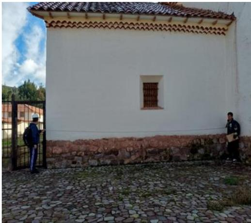
**Fotografía 12:** Medición de dimensiones de los elementos capillas de ambas iglesias.
