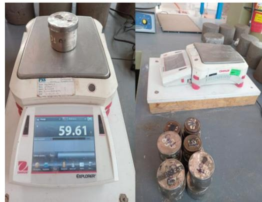
**Fotografía 39:** Pesado de muestras para la determinación de límite líquido y límite plástico
