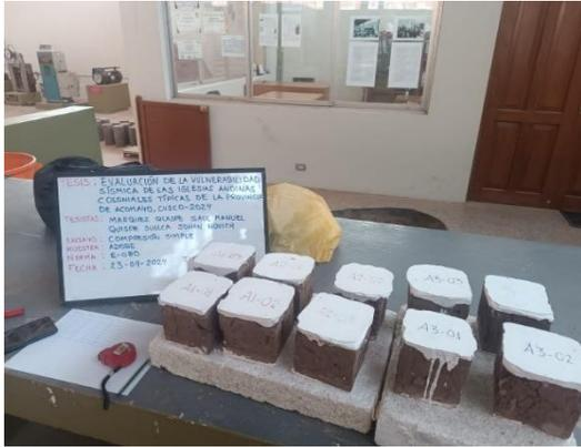
**Fotografía 22:** Muestras después de secado de capping en el laboratorio de la FIC.
