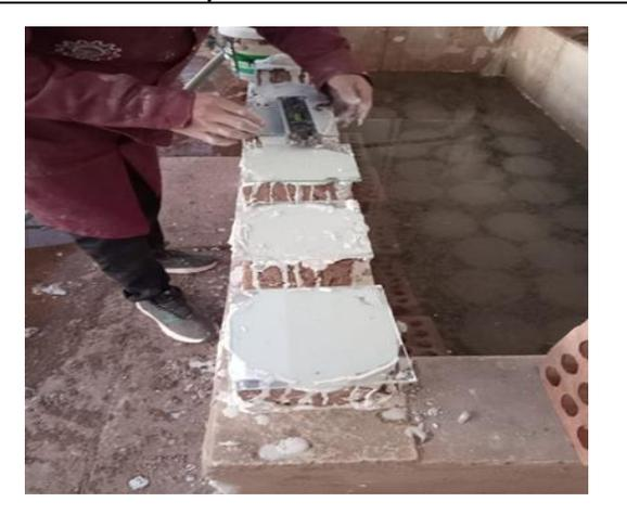
**Fotografía 21:** Colocación de Capping sobre muestras (cubos) de adobe.
