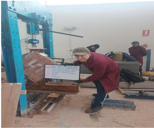
**Figura 60.** Ensayo de compresión diagonal o tracción directa de muretes número 05.
