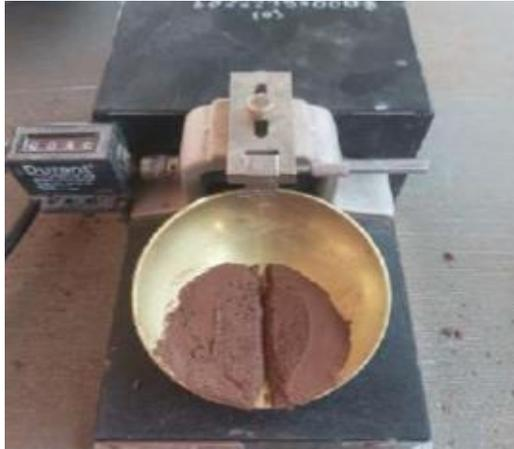
**Fotografía 36:** Determinación del límite líquido de la muestra húmeda en la cuchara de Casagrande
