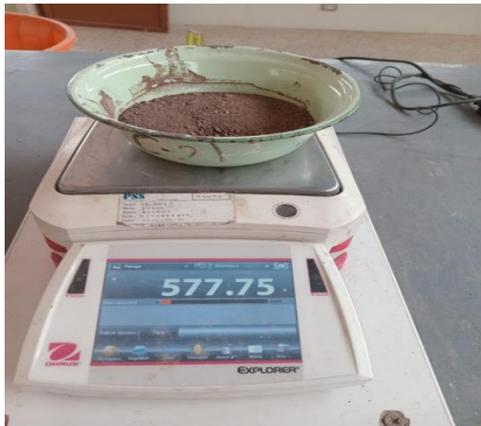
**Fotografía 30:** Pesado de muestra seca después del lavado.
