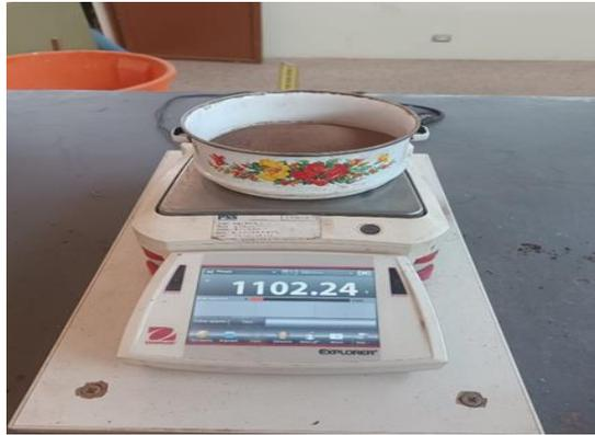
**Fotografía 34:** Peso de muestra seca y tamizado por tamiz N°40.
