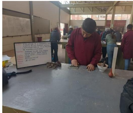
**Fotografía 37:** Realización de ensayo de límite plástico del adobe y mortero.
