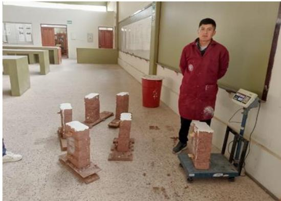
**Figura 54:** Medición de peso de pilas y muretes de mampostería de adobe.
