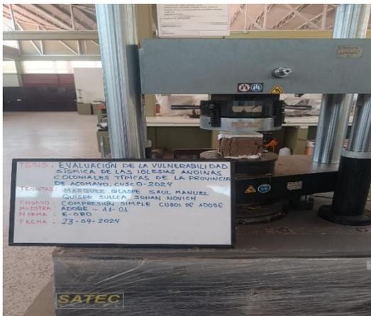
**Fotografía 24:** Espécimen (cubo) de adobe después de ensayo a compresión simple.
