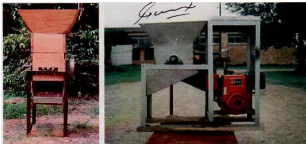
Imagen N°1. Rallos mecánicos para achira diseñados por CORPOICA.
