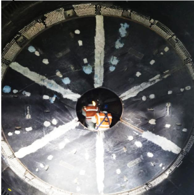
Nota: Ingreso al Tromel del Molino de bolas 2 para monitoreo de condiciones de los chutes internos, técnica NDT ensayos no destructivos, tintes penetrantes y medición de espesores técnica Ultra Sonido UT.
