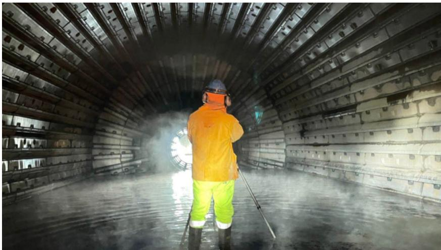
Ingreso al Molino SAG 01 para monitreo de condiciones, monitero laser y de espesores, UT. Trabajo de alto riesgo por ser un espacio conficado con deficiencia de oxigeno y presencia de otros gases tóxicos.
