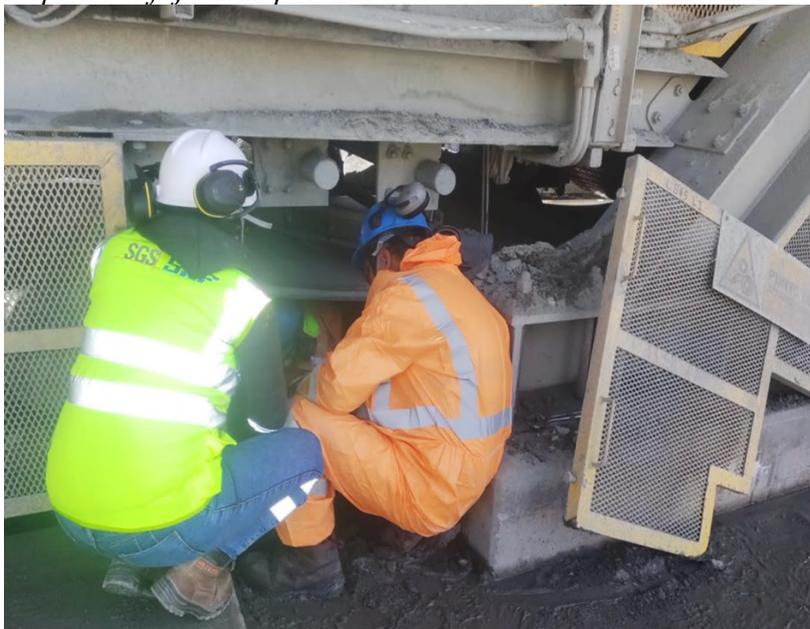
Nota: Elaboración propia. Monitoreo de condiciones del estado de las fajas transportadores, poleas de transmisión, polines, mainshaft y lifshaft, técnica UT VT ultra sonido, phased array. Se considera trabajo de alto riesgo por
