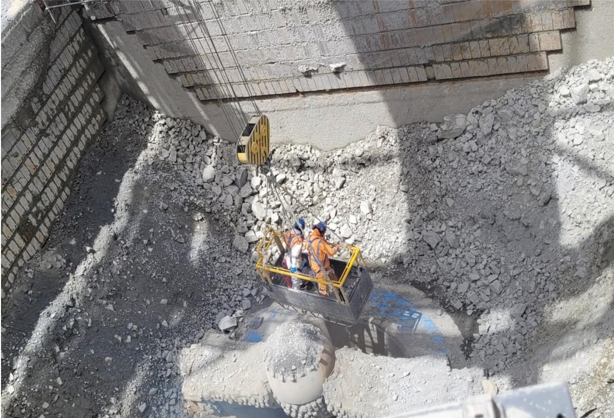
Nota: Elaboración propia. Monitoreo de condiciones de la chancadora primaria parte interna del manto (topshell, middle shell) técnica phased array, seguimiento a la fisura presente y verificación la aparición de nuevas fisuras internas o externas. Monitoreo externo con laser a los liners de las paredes de la chancadora.
