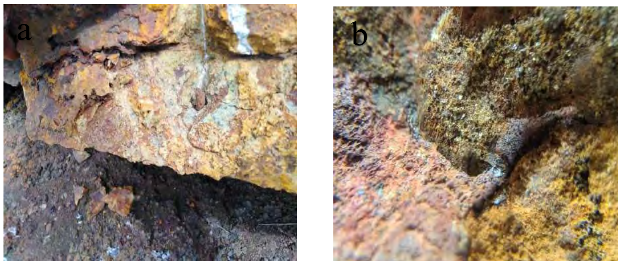
Fotografía 26: a) Roca fuertemente alterada presencia de óxidos de hierro y arcillas. b) Vista de concreciones ferruginosas con Pirita cubica con posible contenido de Au. Fuente propia
