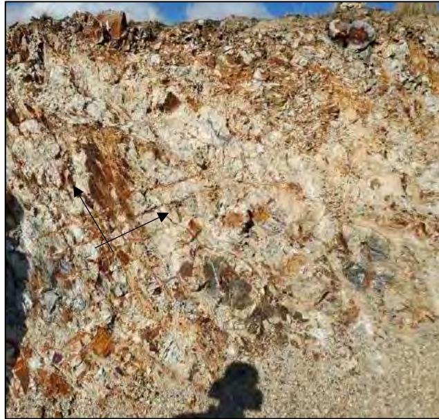
Fotografía 45: Sistema de vetillas horizontes poli direccionales en rejilla Dirección S70°E, N20E Fuente propia
