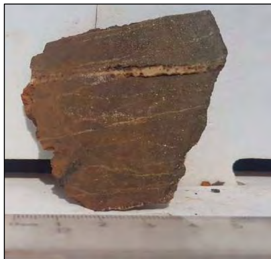
Fotografía 30. Venillas de pirita y diseminada, presencia de pirrotina e intersección de venilla de cuarzo hidrotermal. Fuente propia
