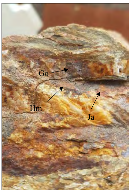
Fotografía 38. Bandas de Cuarzo lechoso Veta victoria (M-2) con Jarosita (Ja), Hematita (Hem), Goetita (Go) y bajo contenido de Au en estos óxidos. Fuente propia
