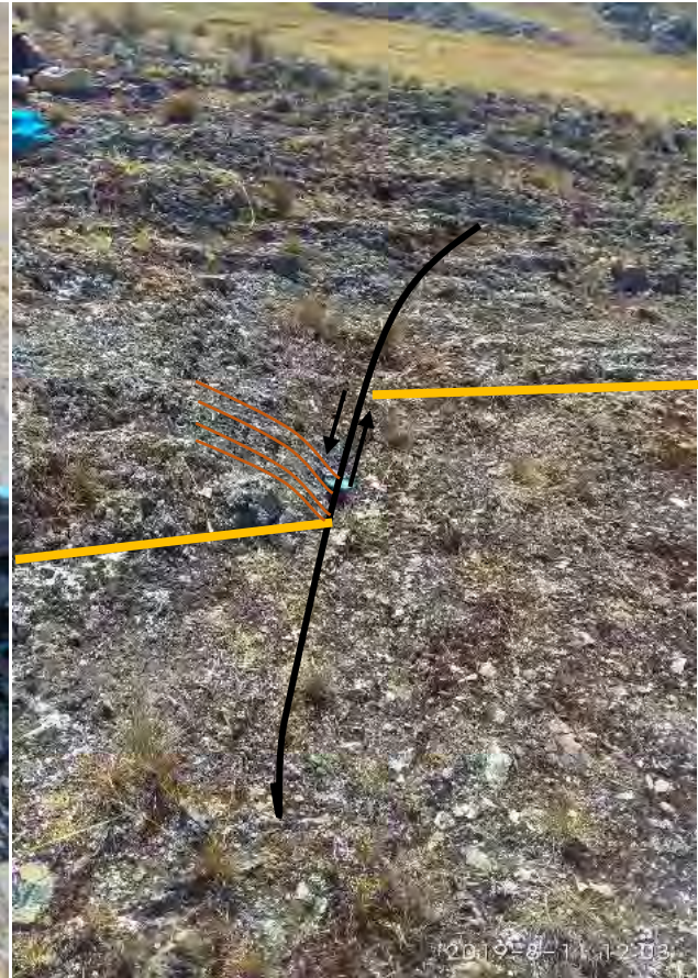
Fotografía 17: Falla inversa dirección N50°O Buzamiento 21°NE. Fuente propia
