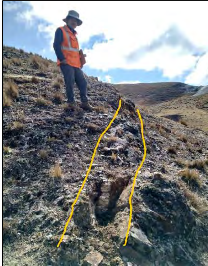
Fotografía 35: Veta Victoria, paralela a la estratificación intercalada de pizarras y esquistos. Dirección N125 Buzamiento N65E. Fuente propia
