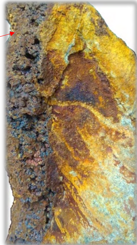
Fotografía 29: Fracturas con relleno de Pirita y en algunos casos trazas de Calco-Py. Alterándose y depositándose como Goetita botroidal- - Hematita. Con contenido menores de Au. Fuente propia
