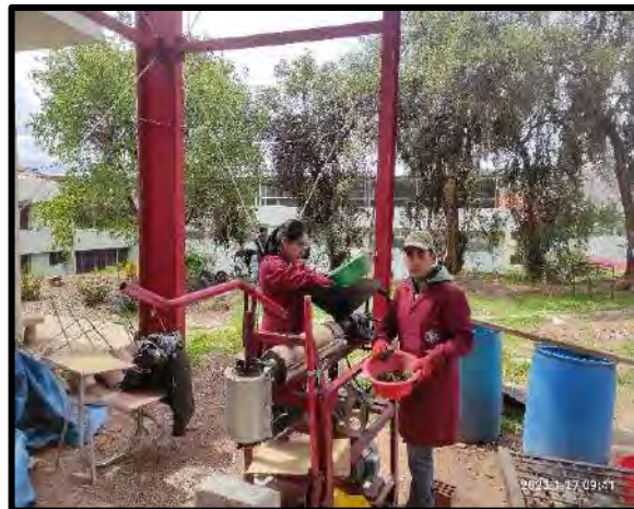
Colocación de arena y polipropileno en tolva de máquina extrusora
