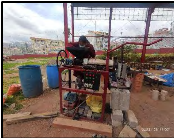
Colocación de arena y polipropileno en tolva de máquina extrusora
