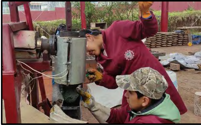
Vaciado de mezcla en molde metálico
