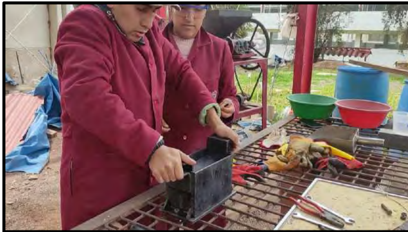
Encofrado de mezcla en molde metálico empernando en costados con la tapa hasta una buena compactación
