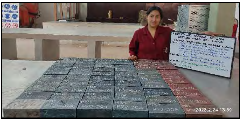
Adoquines 70% polipropileno y 30% arena
