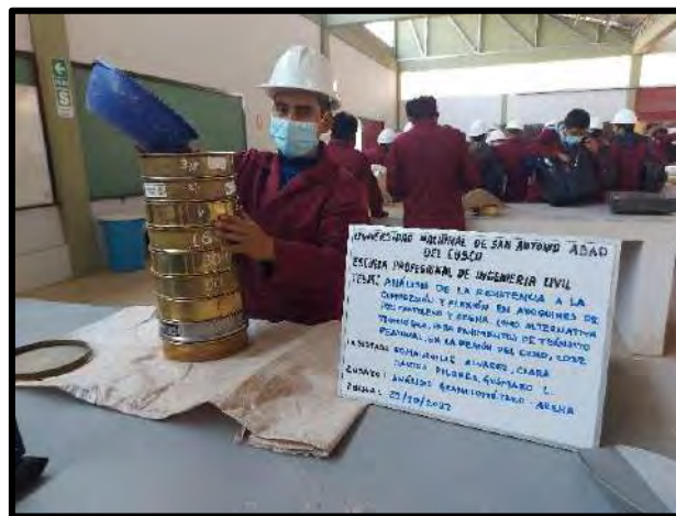
Zarandeo de arena fina de Cunyac
