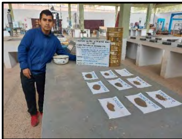
Retenidos en los tamices de Confitillo de Vicho sin lavar
