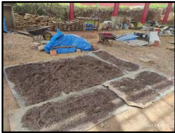
Lavado y secado de confitillo de Vicho
