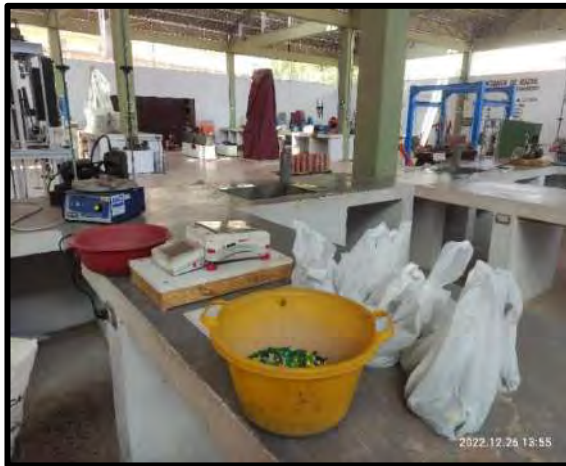
Dosificación de arena (A) y plástico polipropileno (PP) en proporciones A60-40PP, A50-50PP, A70-30PP
