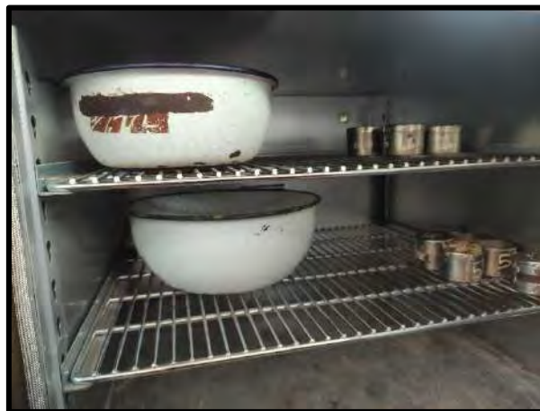
Contenido de humedad de confitillo de Vicho
