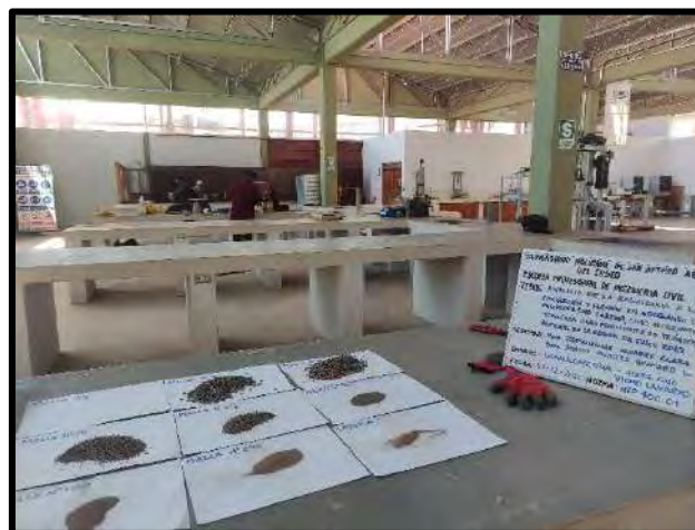
Retenidos en tamices de confitillo de Vicho Lavado
