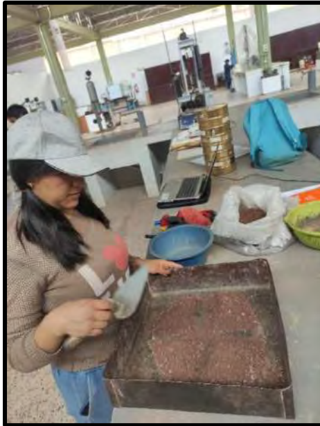
Toma de muestra de Confitillo de Vicho sin lavar
