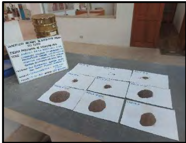
Tamizado de Agregado Fino de Pisac
