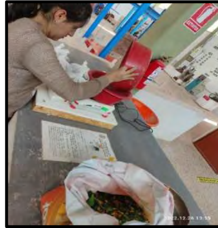
Dosificación de arena (A) y plástico polipropileno (PP) en proporciones A60-40PP, A50-50PP, A70-30PP
