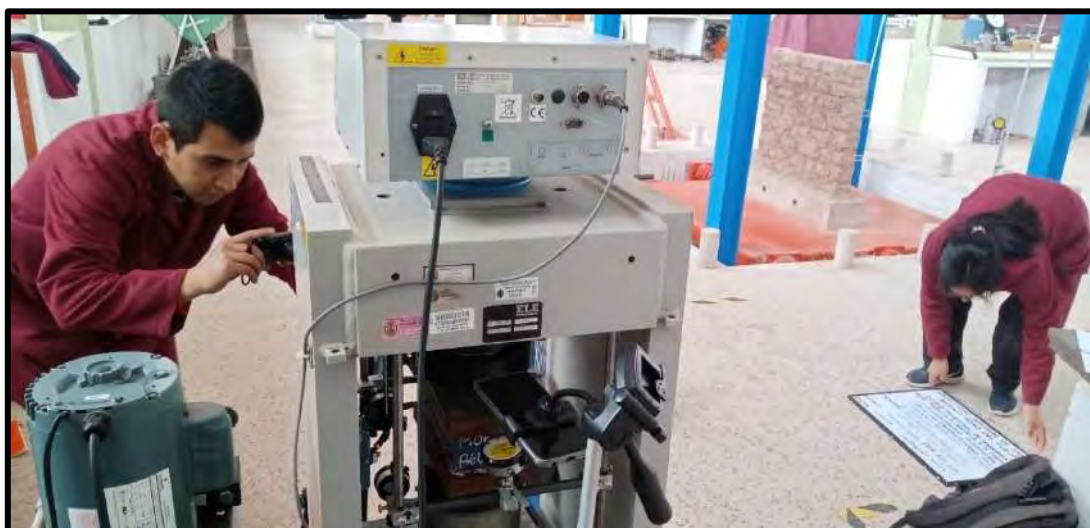
Instalación de cámaras para rotura de adoquines y registro de deformaciones
