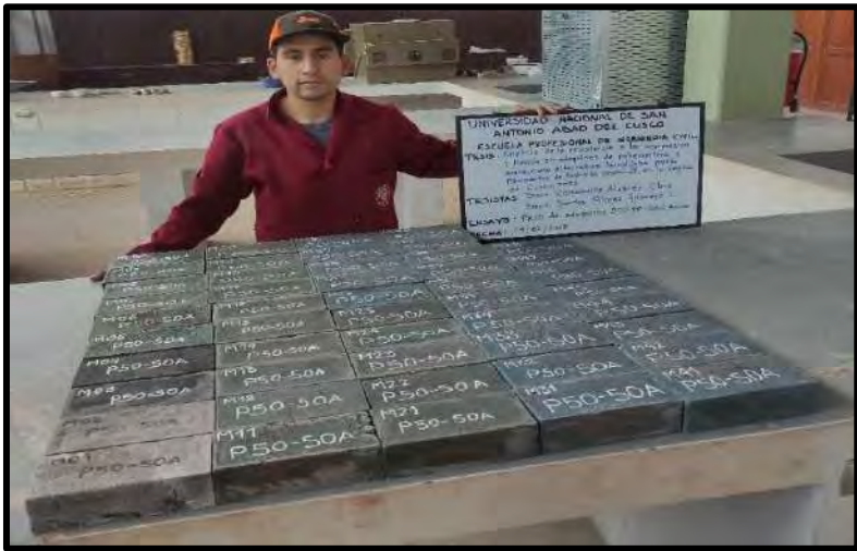
Adoquines 50% polipropileno y 50% arena
