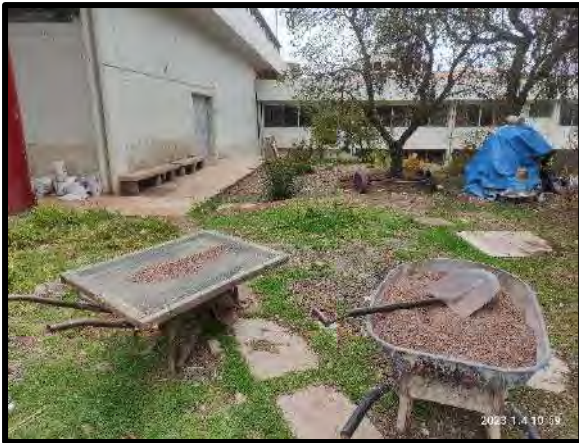
Zarandeo de confitillo de Vicho pasante de la malla N°10 y retenido en la malla N°200
