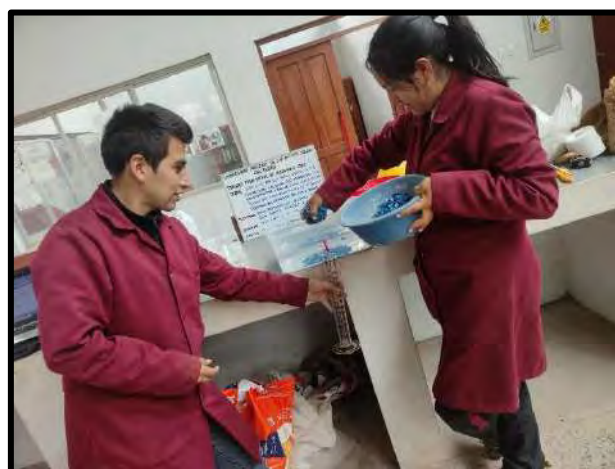
Colocación de plástico polipropileno a envase de alcohol con orificio, el cual por rebose se mide en la probeta para determinar el peso específico del polipropileno
