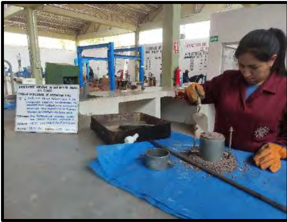
Peso unitario suelto y compactado de confitillo de Vicho
