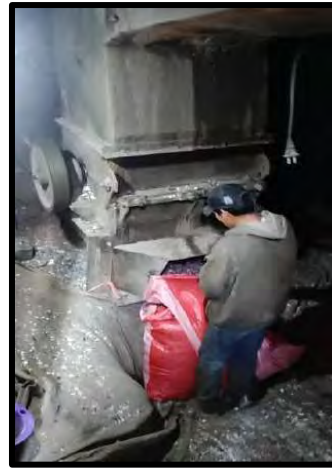
Colocación en la trituradora y ensacado de material reciclado de tipo 5 (polipropileno)
