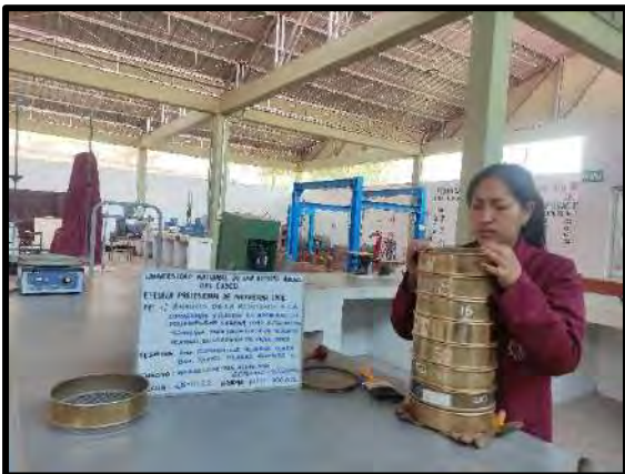
Granulometría Agregado Fino 60% Vicho-40% Cunyac
