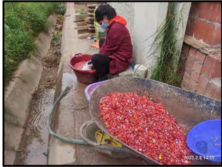
Lavado de plástico polipropileno, eliminando suciedad, objetos metálicos entre otros
