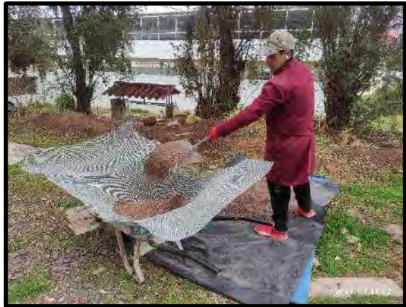
Zarandeo de confitillo de Vicho pasante de la malla N°10 y retenido en la malla N°200
