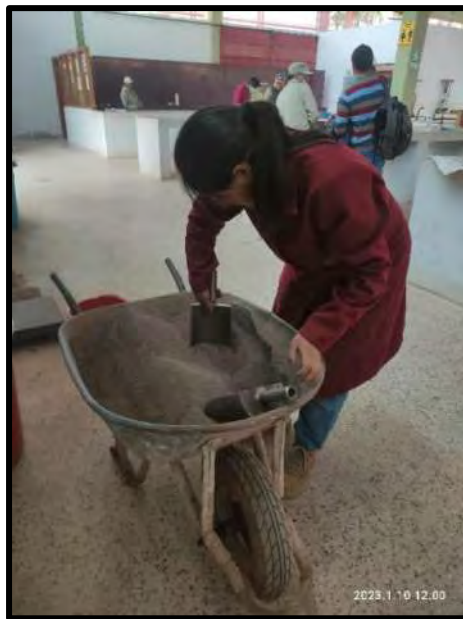
Mezclado de proporción 60-40 (Confitillo Vicho-Arena Fina Cunyac)
