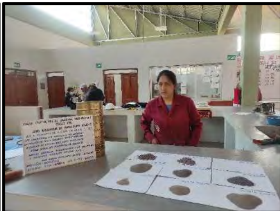
Granulometría Agregado Fino 60% Vicho-40% Cunyac
