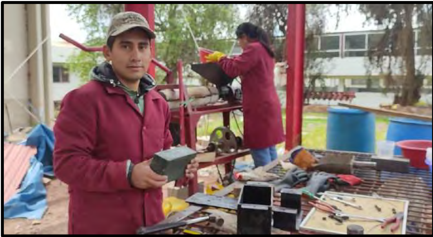
Desencofrado del adoquín
