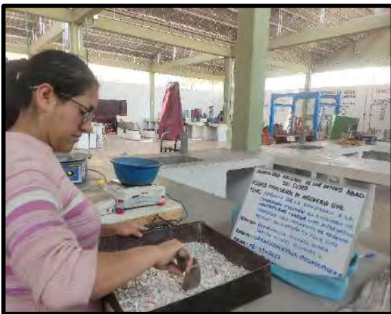
Granulometría plástico polipropileno
