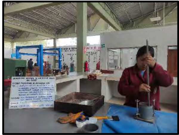
Peso unitario suelto y compactado de confitillo de Vicho
