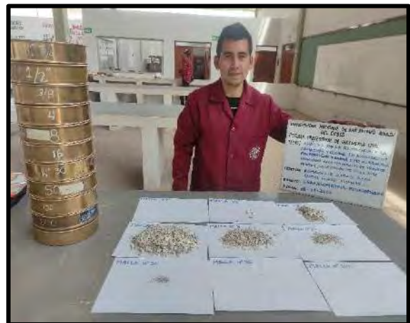
Granulometría plástico polipropileno
