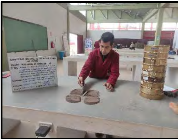
Tamizado de Agregado Fino de Pisac
