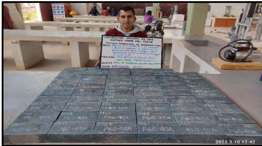
Adoquines 60% polipropileno y 40% arena
