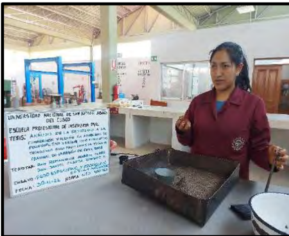
Gravedad especifica y absorción de agregado 60% Vicho-40% Cunyac
