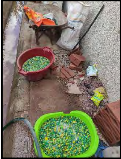
Lavado de plástico polipropileno, eliminando suciedad, objetos metálicos entre otros
