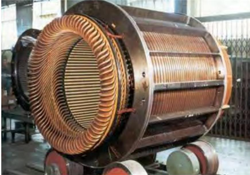
**Figura 2.2 Armadura del Alternador.**
