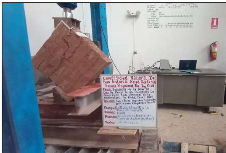
Figura 129. Estado de muretes después del ensayo compresión diagonal con adicción de 4% de fibra de caña de azúcar.
