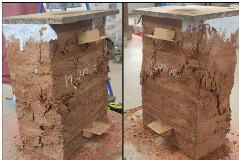
Figura 66. Falla Cónica en Pila muestra M 3 4F 05
