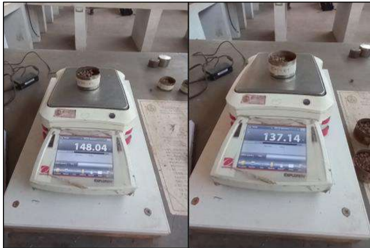
Figura 97. Peso (Muestra + Capsula) de muestra 1 y muestra 2 antes de colocar al horno.
