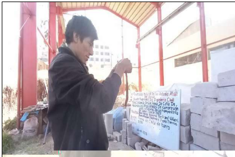
Figura 6. Prueba de cinta de barro.
