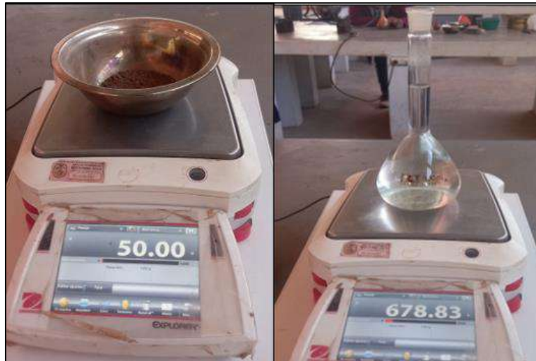
Figura 103. Peso de suelo y peso de (matraz + Agua)
