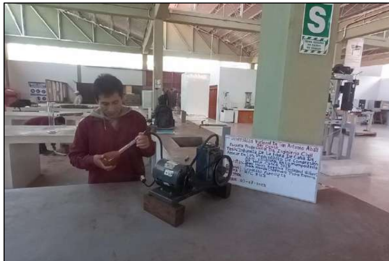
Figura 104. Extracción de aire con bomba de vacíos.
