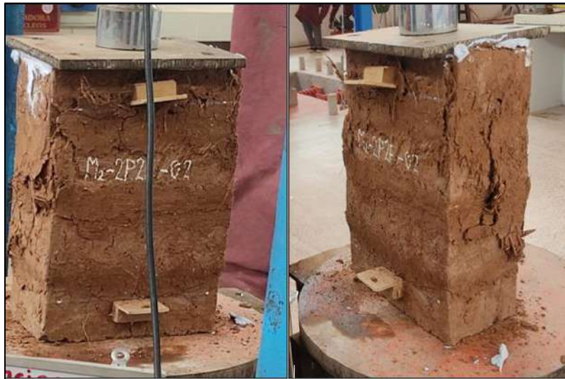
Figura 62. Falla por Cortante en Pila muestra M 2 2P2F 02
