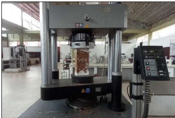
Figura 135. Estado de unidades de adobe antes del ensayo compresión simple en la maquina UNIVERSAL.
