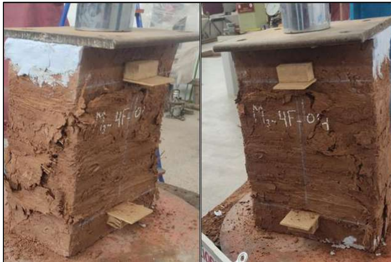
Figura 65. Falla Cónica en Pila muestra M 3 4F 04
