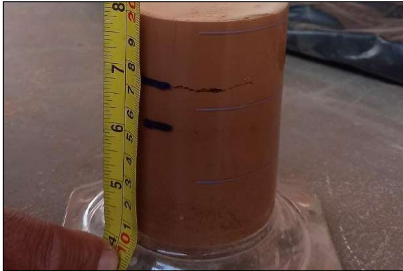
Figura 9. Medición de espesores de arcilla, limo y arena
