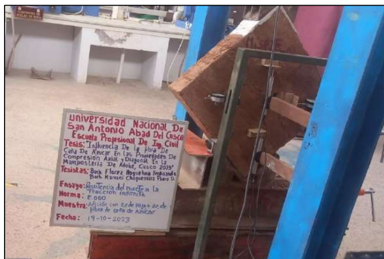
Figura 126. Estado de muretes antes del ensayo compresión diagonal con adicción de 2% de paja + 2% de fibra de caña de azúcar.
