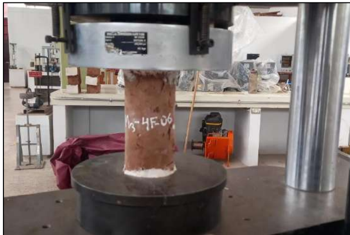
Figura 137. Ensayo compresión simple en cilindros de 3"x6" con adición de 4% de fibra de caña de azúcar.
