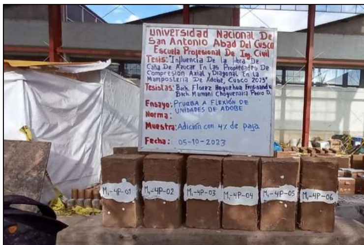
Figura 141. Unidades de adobe para ensayo tracción a flexión con adicción 4% de paja.
