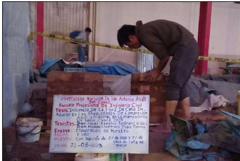
Figura 115. Elaboración de muretes con adición 2% de paja + 2% de fibra de caña de azúcar.
