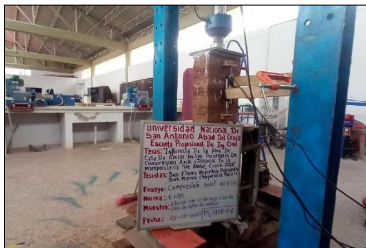
Figura 120. Estado de pilas antes del ensayo compresión axial con adicción de 2% de paja + 2% de fibra de caña de azúcar.
