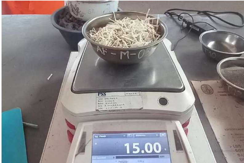
Figura 10. La masa de la fibra de caña de azúcar medida a través de una balanza electrónica.
