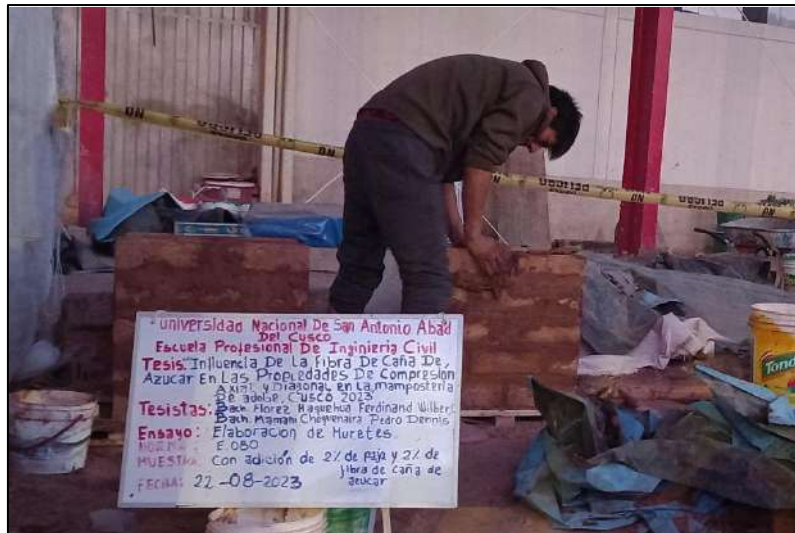
Figura 50. Elaboración de muretes con adición de 2% de paja + 2% de fibra de caña de azúcar.
