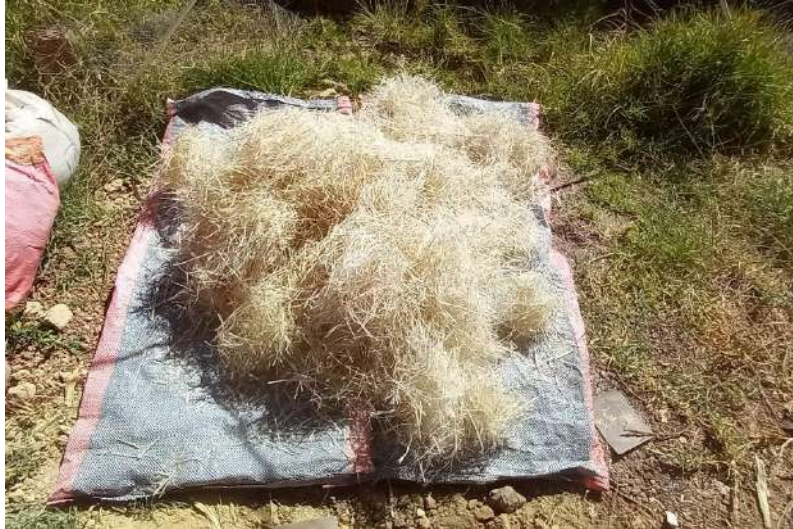
Figura 18. Fibra de caña de azúcar deshilachado.
