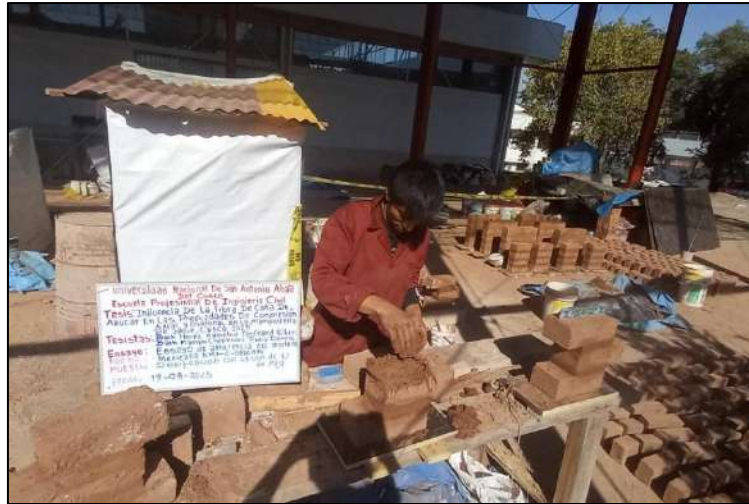
Figura 41. Elaboración de probetas de tres piezas con adición de 4% de paja.
