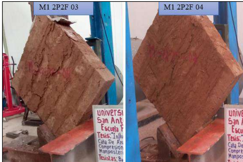
Figura 77. Falla de cortante.
