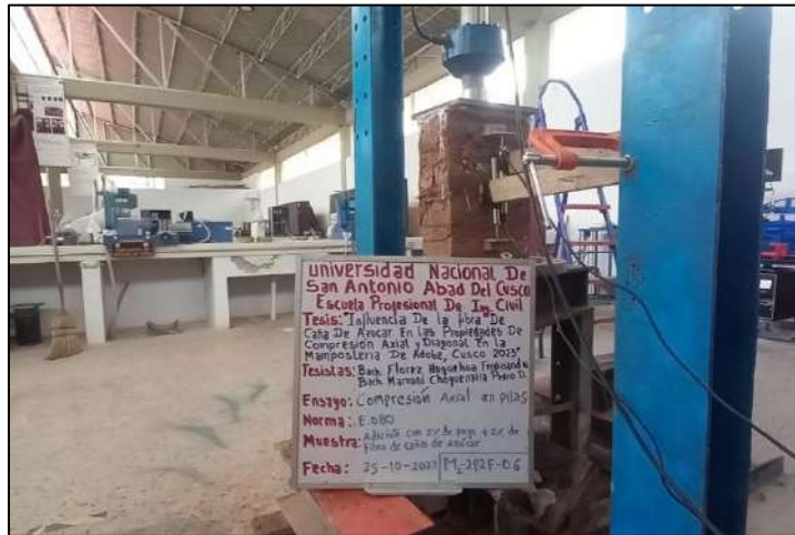
Figura 121. Estado de pilas después del ensayo compresión axial con adicción de 2% de paja + 2% de fibra de caña de azúcar.
