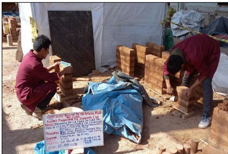
Figura 47. Elaboración de pilas con adición de 2% de paja + 2% de fibra de caña de azúcar
