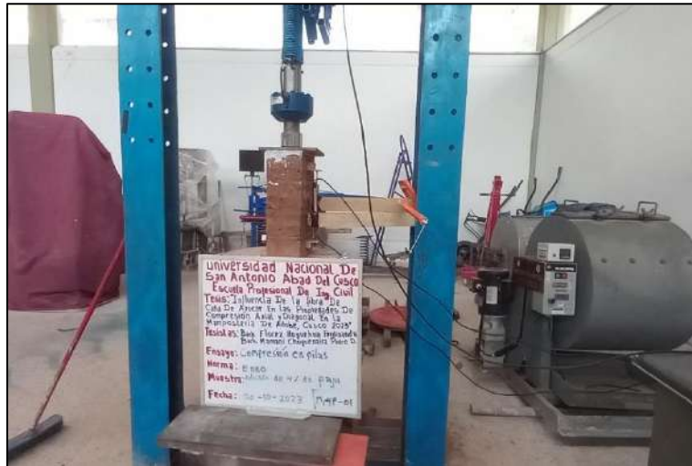
Figura 118. Estado de pilas antes del ensayo compresión axial con adicción de 4% de paja.
