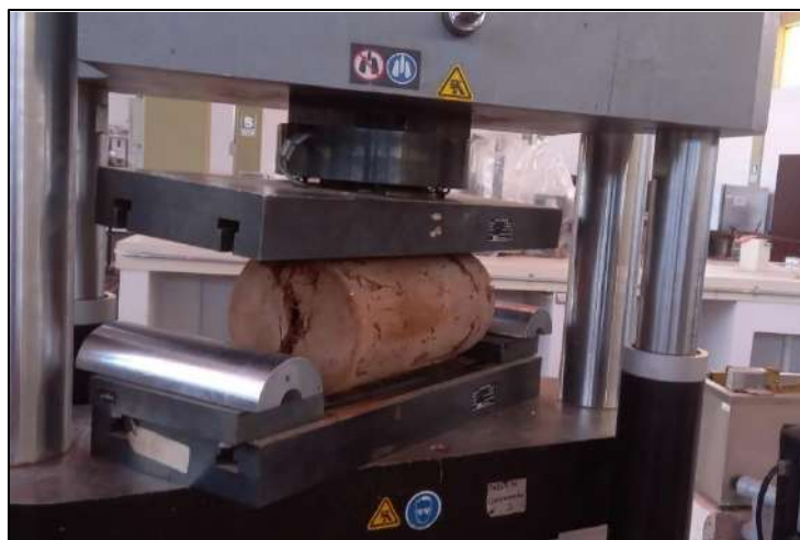
Figura 147. Estado de cilindros de 6"x12" después del ensayo tracción indirecta en la maquina UNIVERSAL.
