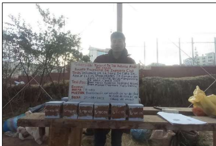
Figura 132. Cubos con adición 2% de paja + 2% de fibra de caña de azúcar.
