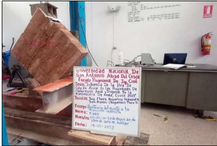
Figura 127. Estado de muretes después del ensayo compresión diagonal con adicción de 2% de paja + 2% de fibra de caña de azúcar.
