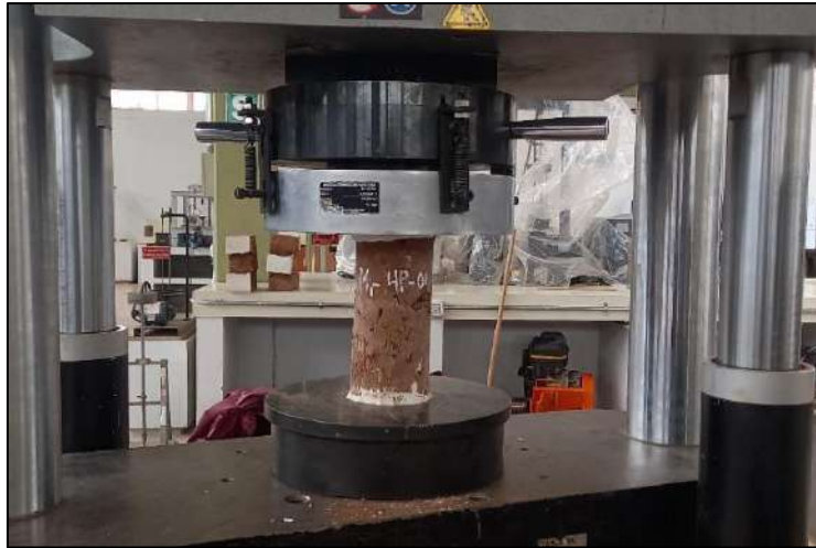
Figura 139. Ensayo compresión simple en cilindros de 3"x6" con adición de 4% de paja.
