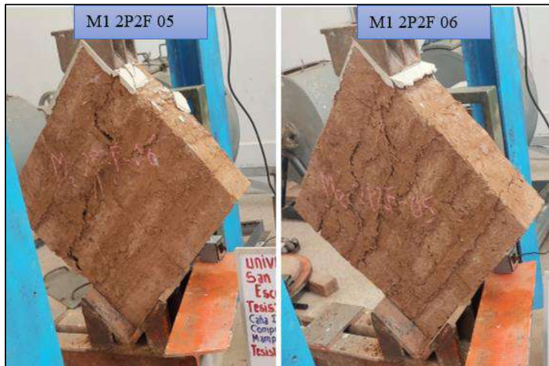
Figura 78. Falla cortante y combinada respectivamente.
