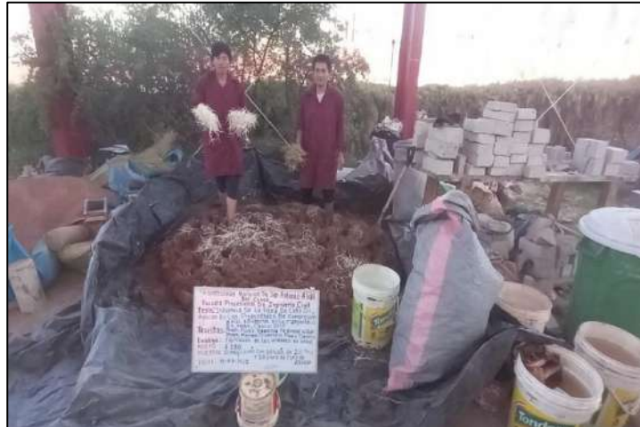
Figura 33. Proceso de preparación de barro para elaborar unidades de adobe con adición con 2% de paja + 2% de fibra de caña de azúcar.
