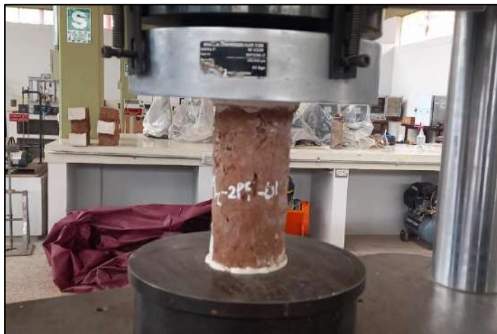
Figura 138. Ensayo compresión simple en cilindros de 3"x6" con adición de 2% de paja + 2% de fibra de caña de azúcar.
