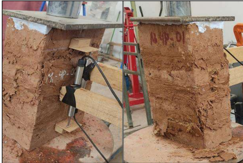
Figura 59. Falla por Cortante en Pila muestra M 1 4P 01
