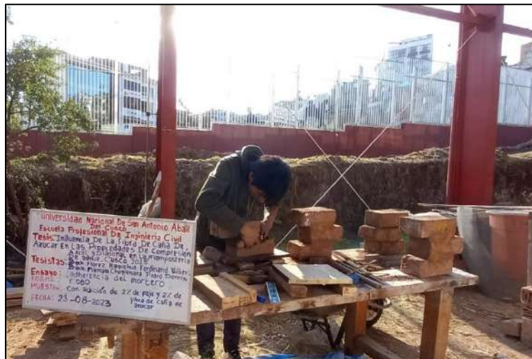
Figura 42. Elaboración de probetas de tres piezas con adición de 2% de paja + 2% de fibra de caña de azúcar.
