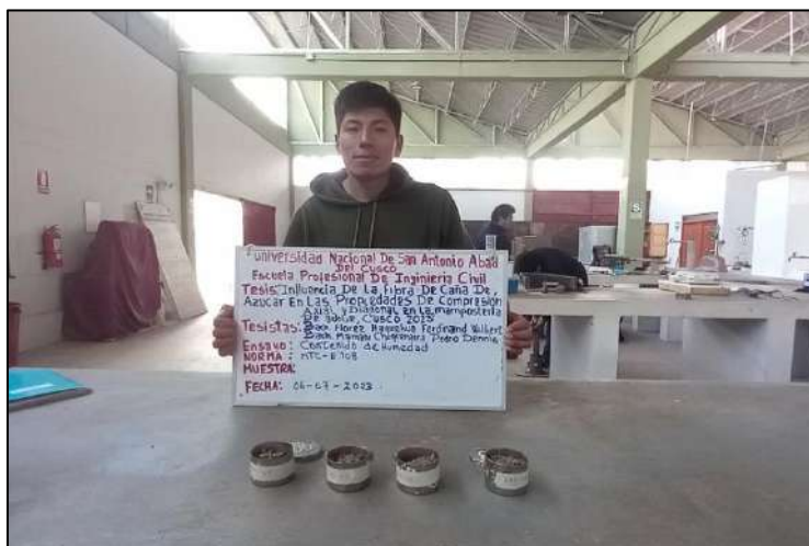
Figura 99. Cuatro muestras en capsulas para ensayo de contenido de humedad.
