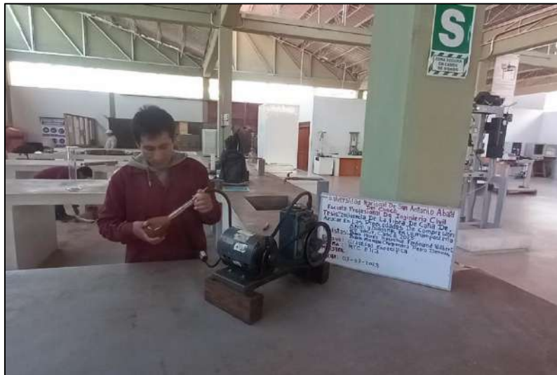
Figura 21. Ensayo de gravedad específica de suelo.
