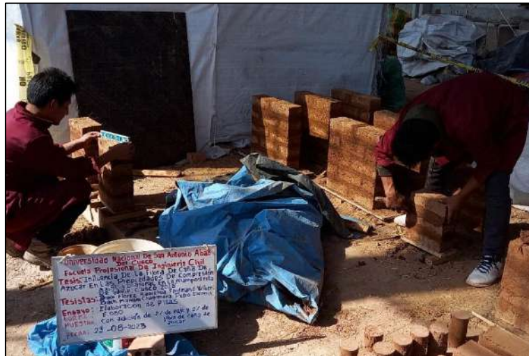
Figura 110. Verificación de horizontalidad con nivel de mano de pilas con adicción 2% de paja + 2% de fibra de caña de azúcar.
