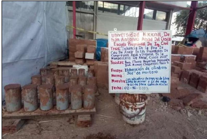
Figura 39. Elaboración de testigos de cilindros de 3"x6".
