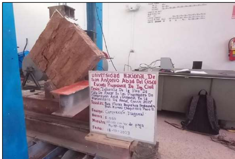
Figura 125. Estado de muretes después del ensayo compresión diagonal con adicción de 4% de paja.
