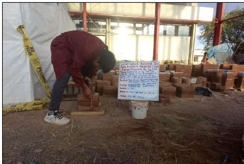
Figura 45. Elaboración de probetas de dos piezas.
