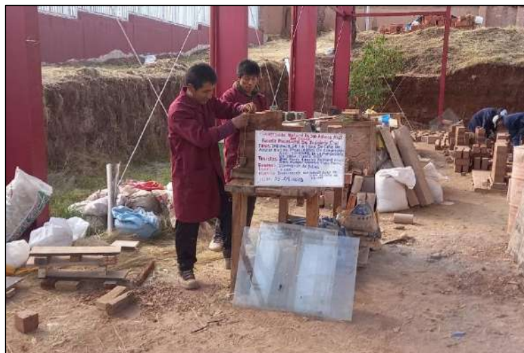
Figura 111. Verificación de verticalidad de pila con adicción 4% de fibra de caña de azúcar.
