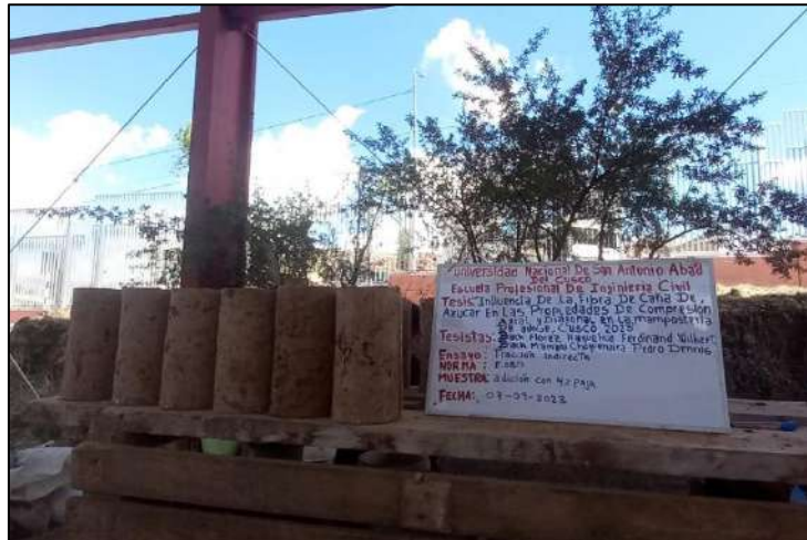
Figura 145. Testigos de cilindros de 6" x 12" con adicción 4% de paja
