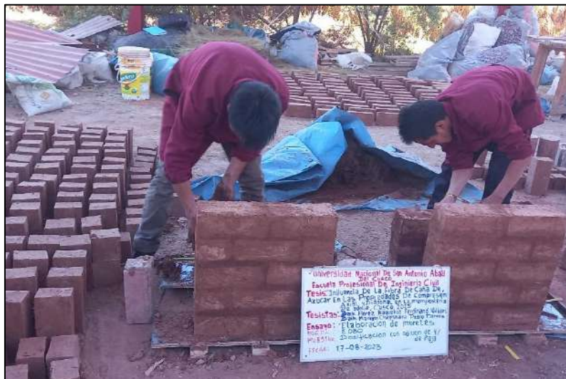
Figura 49. Elaboración de muretes con adición de 4% de paja.
