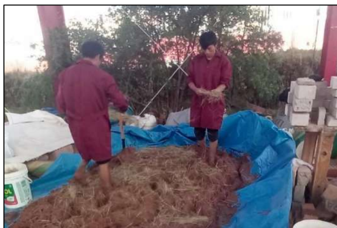
Figura 32. Proceso de preparación de barro para elaborar unidades de adobe con adición con 4% de paja.
