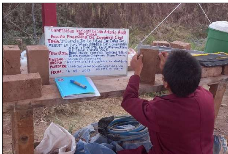
Figura 53. Medición de ancho de la unidad de adobe.
