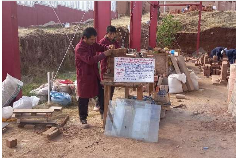
Figura 48. Elaboración de pilas con adición de 4% de fibra de caña de azúcar.
