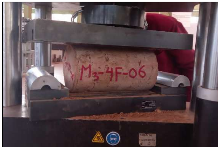
Figura 146. Estado de cilindros de 6"x12" antes del ensayo tracción indirecta en la maquina UNIVERSAL.
