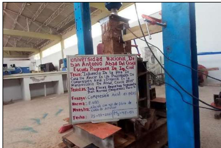
Figura 123. Estado de pilas después del ensayo compresión axial con adicción de 4% de fibra de caña de azúcar.
