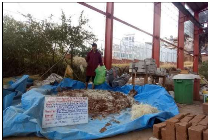
Figura 34. Proceso de preparación de barro para elaborar unidades de adobe con adición con 4% de fibra de caña de azúcar.
