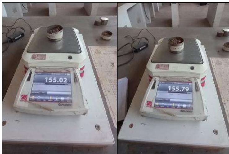
Figura 98. Peso (Muestra + Capsula) de muestra 3 y muestra 4 antes de colocar al horno.
