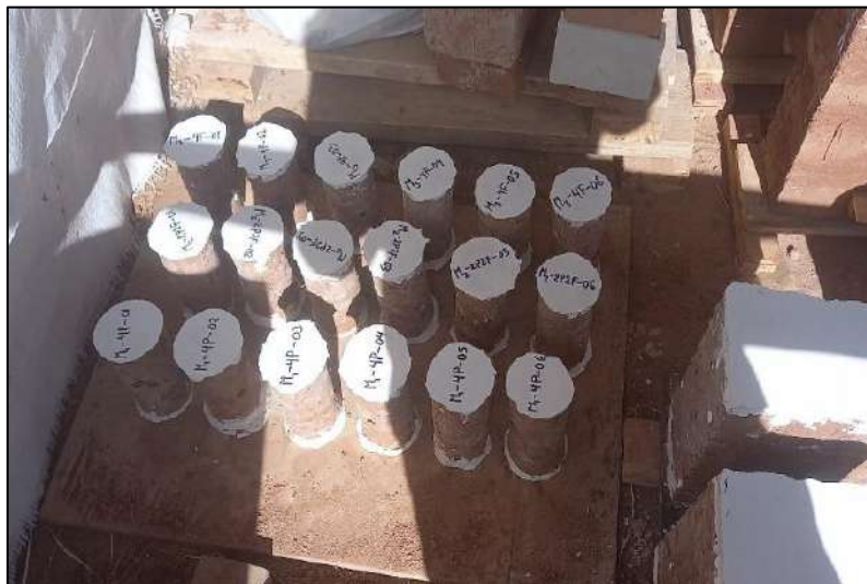
Figura 40. Secado de testigos de cilindro de 3"x6".
