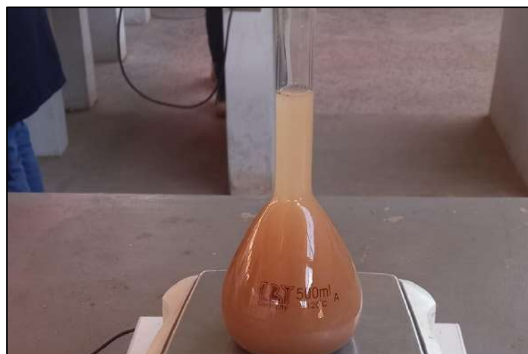
Figura 105. Peso (Matraz + Agua + Suelo).
