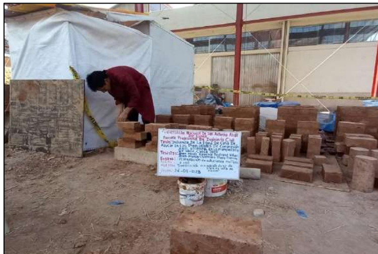
Figura 43. Elaboración de probetas de tres piezas con adición de 2% de paja + 2% de fibra de caña de azúcar.
