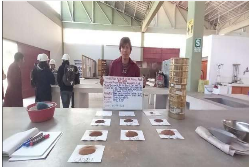
Figura 23. Ensayo de análisis granulométrico del suelo.
