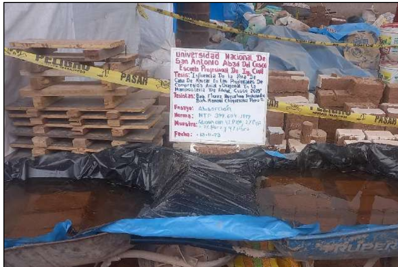
Figura 54. Proceso de saturación con adición de 4% de paja, 2% de paja + 2% de fibra de caña de azúcar y 4% de fibra de caña de azúcar.
