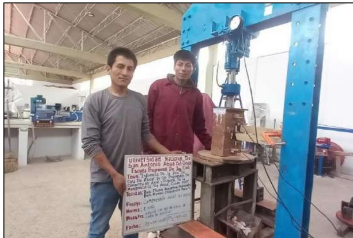
Figura 122. Estado de pilas antes del ensayo compresión axial con adicción de 4% de fibra de caña de azúcar.
