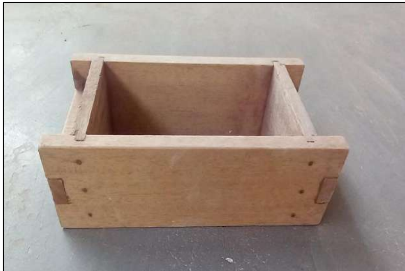
Figura 1. Molde de madera de la unidad de adobe a usar.
