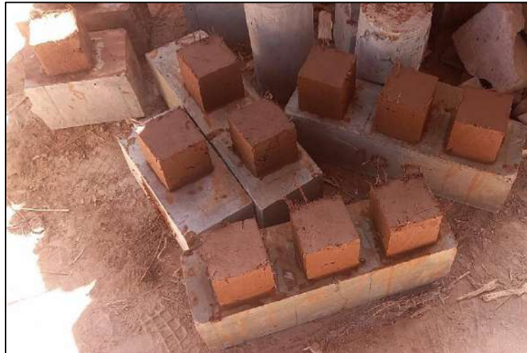
Figura 130. Elaboración de cubos de 10cm de lado
