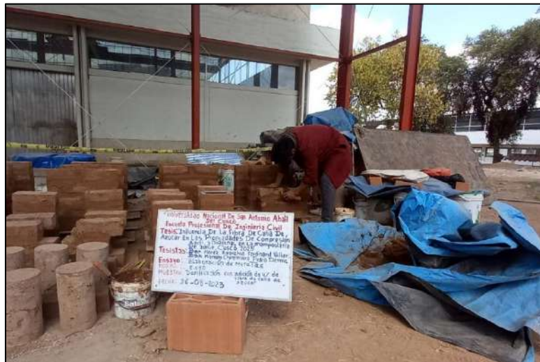
Figura 116. Elaboración de muretes con adición 4% de fibra de caña de azúcar.
