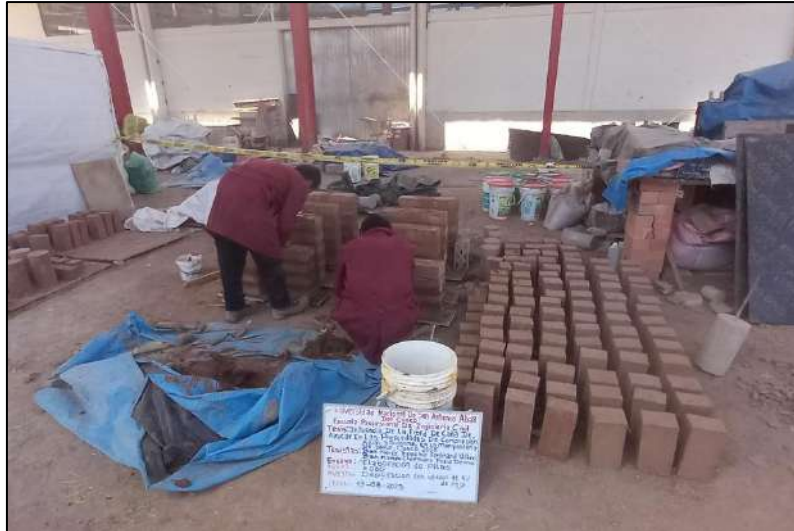
Figura 46. Elaboración de pilas con adición de 4% de paja.
