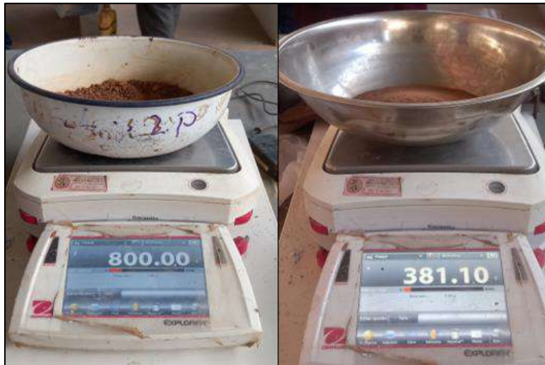
Figura 101. Pesado de suelo antes de lavar y después de poner al horno
