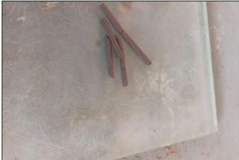
Figura 27. Ensayo de limite plástico.
