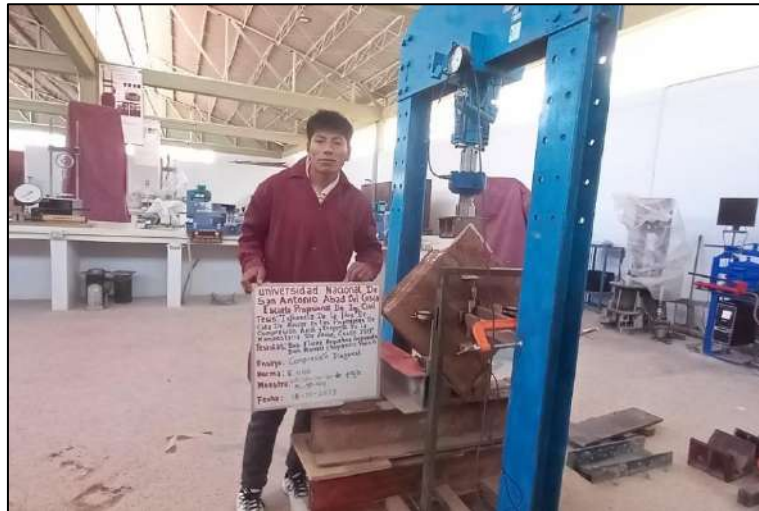
Figura 124. Estado de muretes antes del ensayo compresión diagonal con adicción de 4% de paja.
