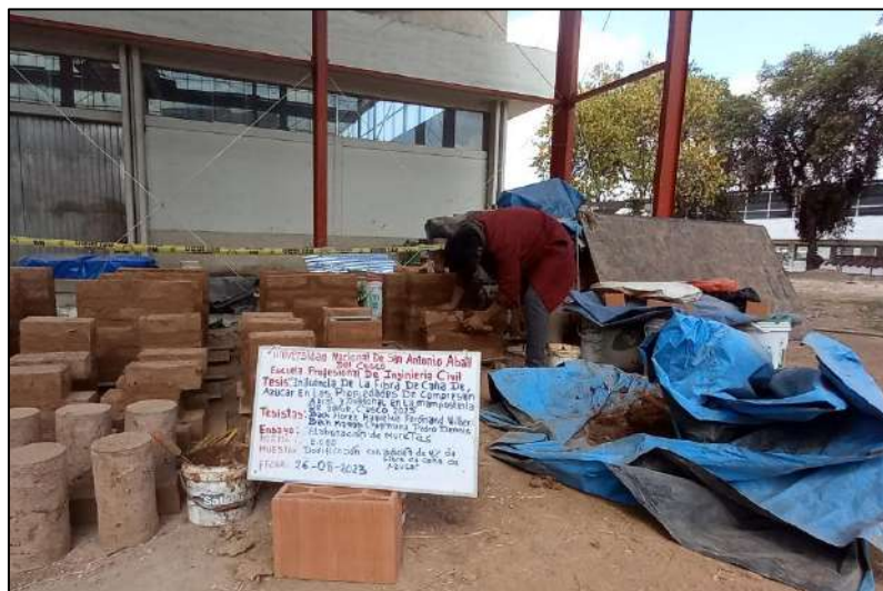
Figura 51. Elaboración de muretes con adición de 4% de fibra de caña de azúcar.
