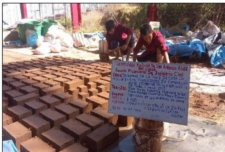
Figura 36. Elaboración de unidades de adobe con adición de 2% de paja + 2% de fibra de caña de azúcar.
