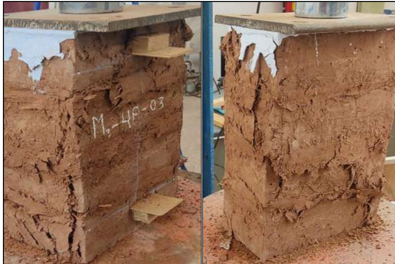
Figura 64. Falla Cónica en Pila muestra M 3 4F 03
