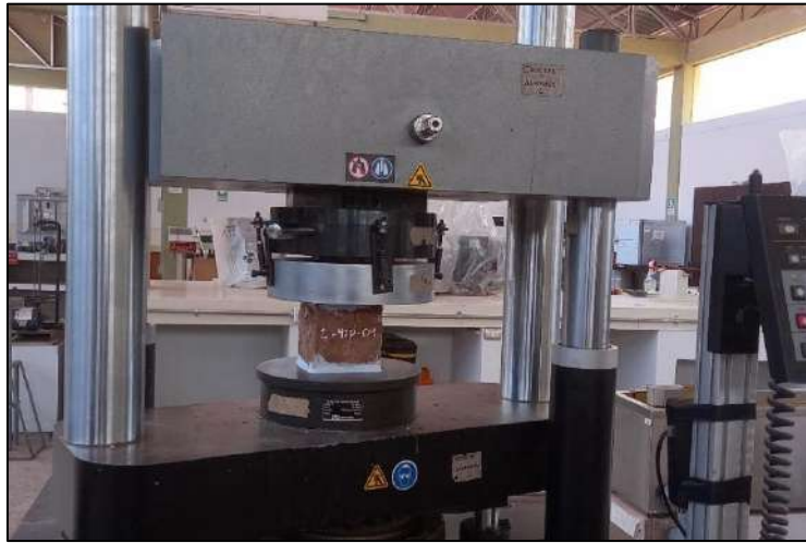
Figura 134. Ensayo de compresión de cubos de 10cm de lado
