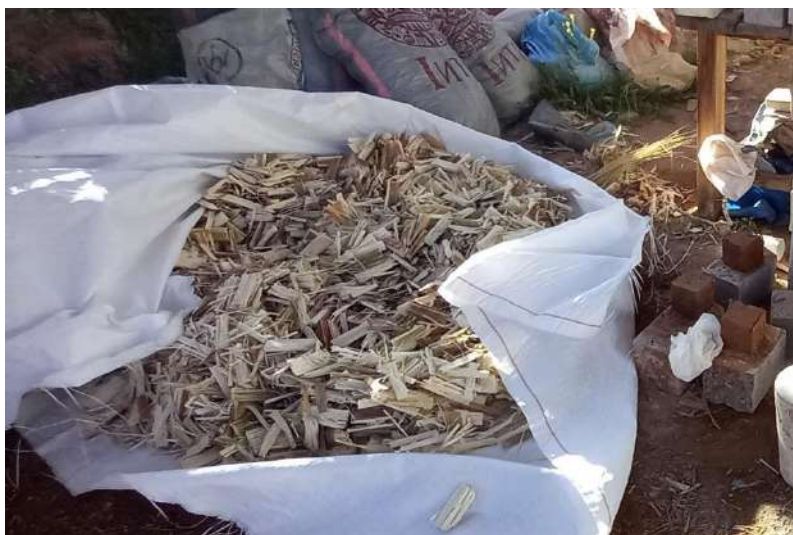
Figura 17. Seccionamiento de fibra de caña de azúcar en 10cm
