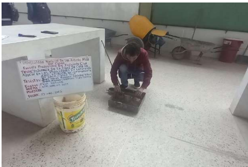
Figura 14. Ensayo de peso unitario NTP.400.017.2011
