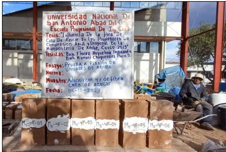
Figura 142. Unidades de adobe para ensayo tracción a flexión con adicción 4% de fibra de caña de azúcar.
