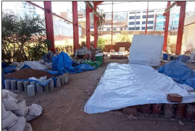
Figura 38. Proceso de secado de unidades de adobe.
