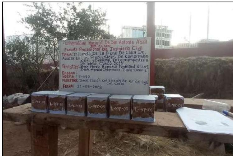
Figura 131. Cubos con adición 4% de paja
