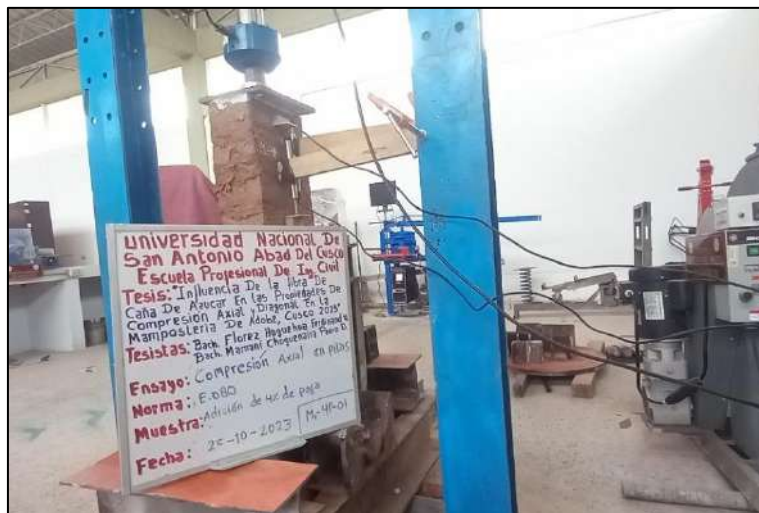
Figura 119. Estado de pilas después del ensayo compresión axial con adicción de 4% de paja.
