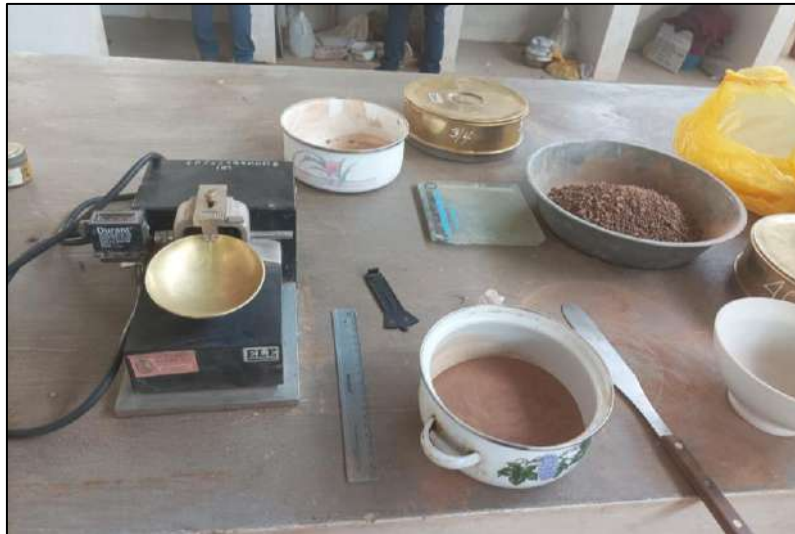
Figura 25. Equipos para ensayo el límite líquido y plástico.
