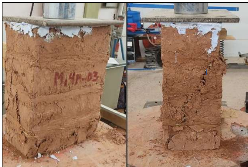
Figura 60. Falla por Cortante en Pila muestra M 1 4P 03
