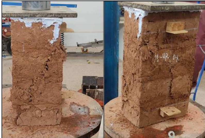
Figura 61. Falla Cónica en Pila muestra M 1 4P 04
