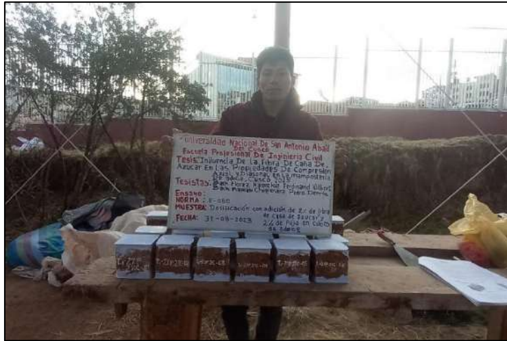
Figura 133. Cubos con adición 4% de fibra de caña de azúcar.
