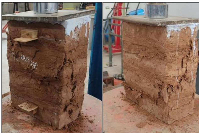
Figura 63. Falla Cónica en Pila muestra M 2 2P2F 06
