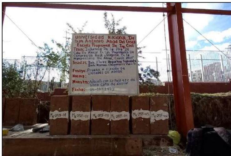
Figura 140. Unidades de adobe para ensayo tracción a flexión con adicción 2% de paja + 2% de fibra de caña de azúcar.
