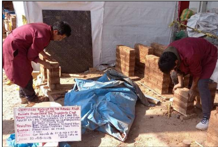
Figura 109. Verificación de verticalidad de pila 2% de paja + 2% de fibra de caña de azúcar.
