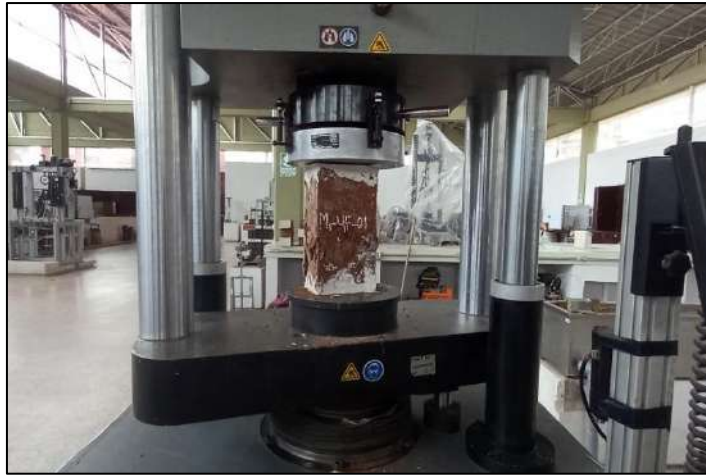
Figura 136. Estado de unidades de adobe después del ensayo compresión simple en la maquina UNIVERSAL.
