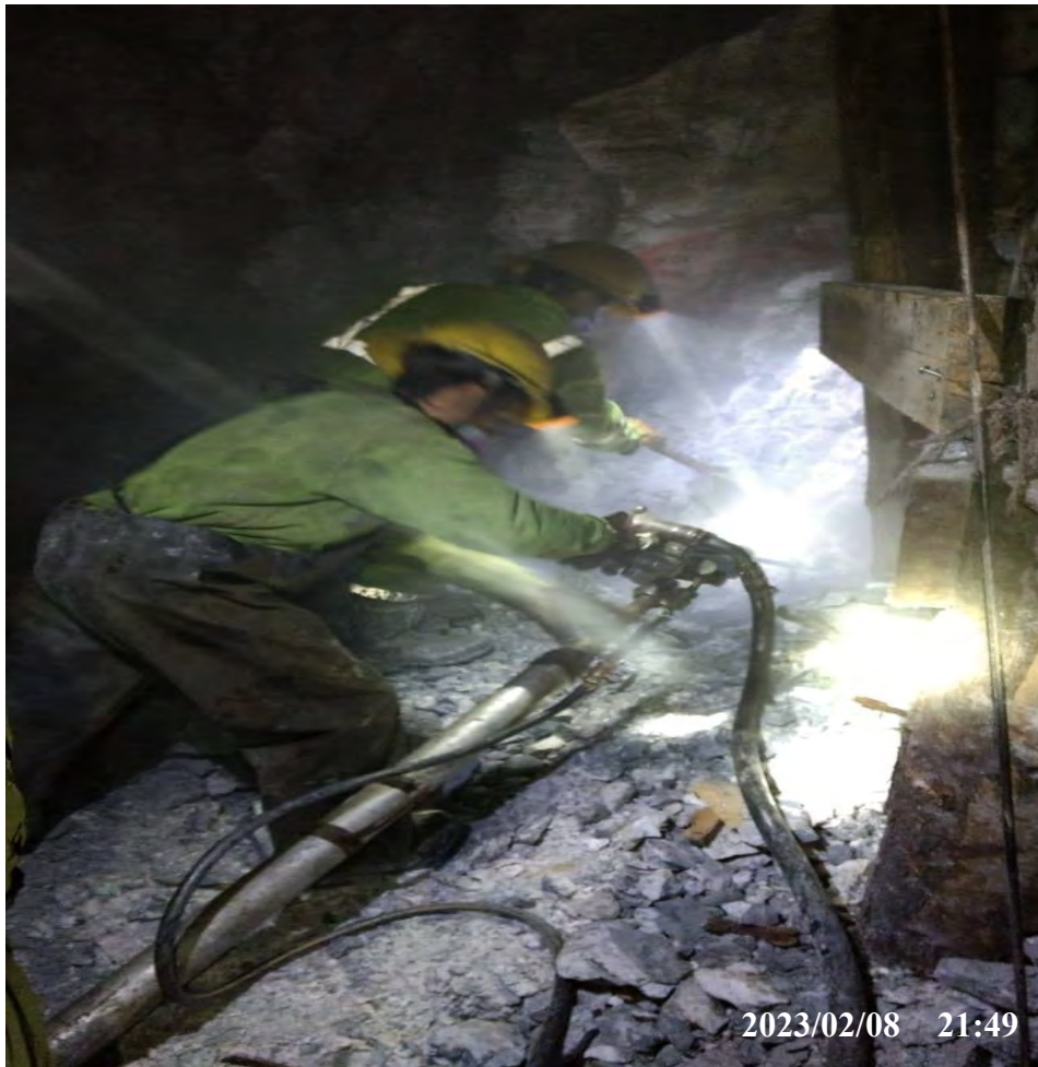
Figura 9. Perforación con maquina RPN martillo neumático Jack Leg RN - 250X
