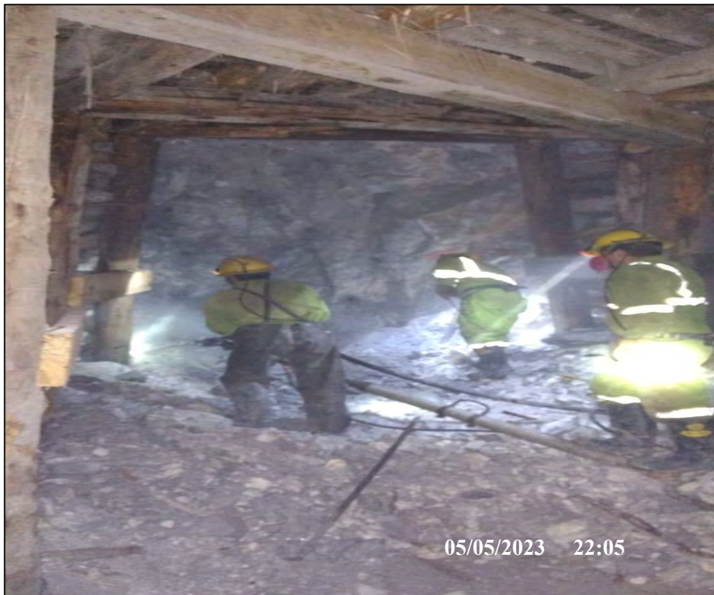
Figura 35. Perforación con Jack Leg RNP RN-250X
