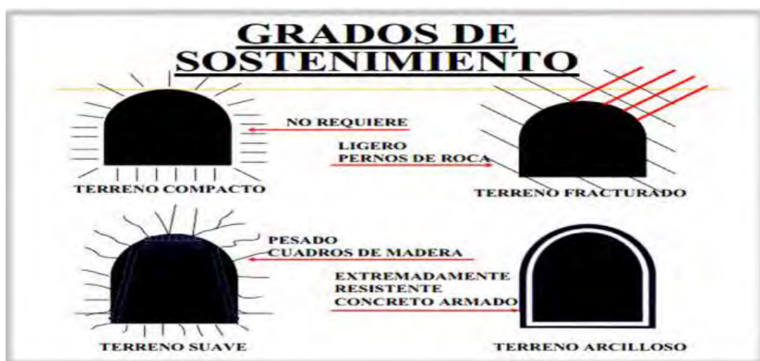
Figura 19. Grados de sostenimiento
