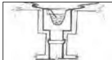
**Imagen 63:** Evacuación de aguas pluviales de faldones.
