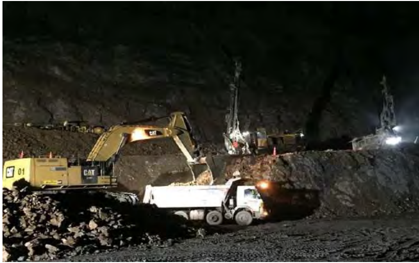
Figura 1: Proceso de carguío – acarreo del tajo Santa Este, minera Iscaycruz.
