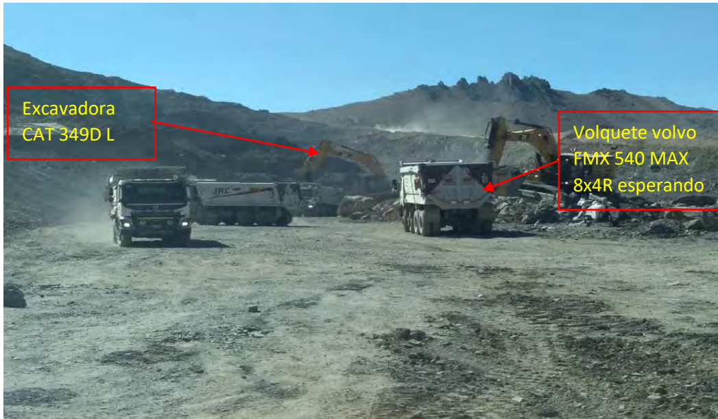
Figura 20: Carguío de la EXC-349D L a los volquetes volvo FMX 540 MAX 8x4R (Mineral)
