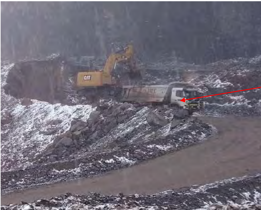
Figura 21: Carguío de la EXC-349D L a los volquetes FMX 540 MAX 8x4R (Desmote)
