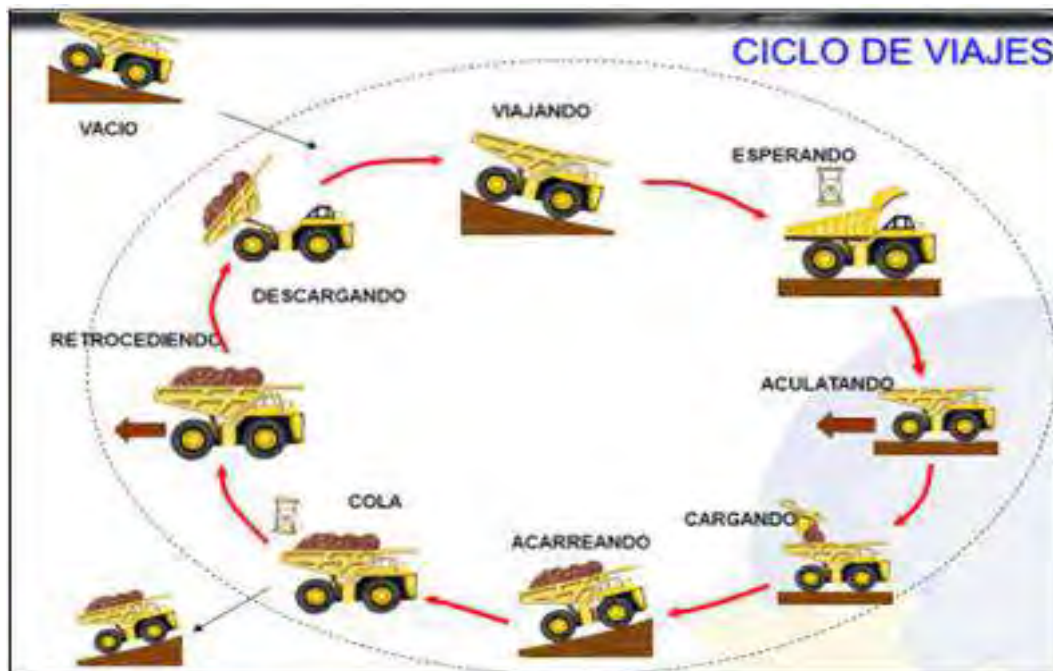
Figura 4: Ciclo de carguío - acarreo en operación mina.
